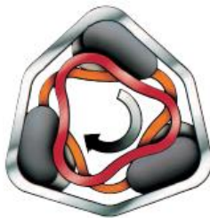
Figura 43. Sistema incorporat suspensió eix.
