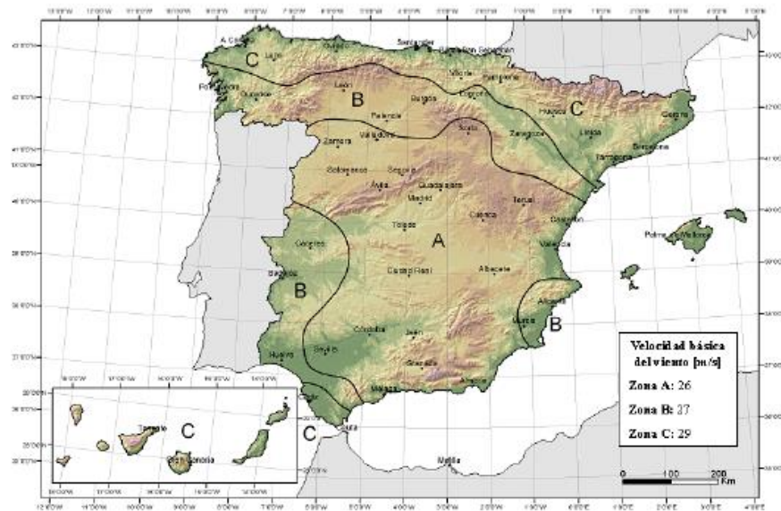
Figura 2. 1 – Valor de la velocitat del vent en funció de la zona geogràfica. Obtingut de la figura D.1 del CTE-DB-SE-AE.
