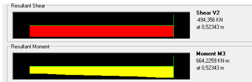
Figura 5. 22 – Diagrama de tallants de l'extrem de la biga corba on el tallant és màxim.
