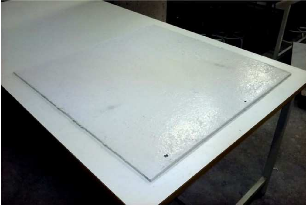
Figura 15. Placa de formigó UHPFRC utilitzada en l'assaig al laboratori de construccions
