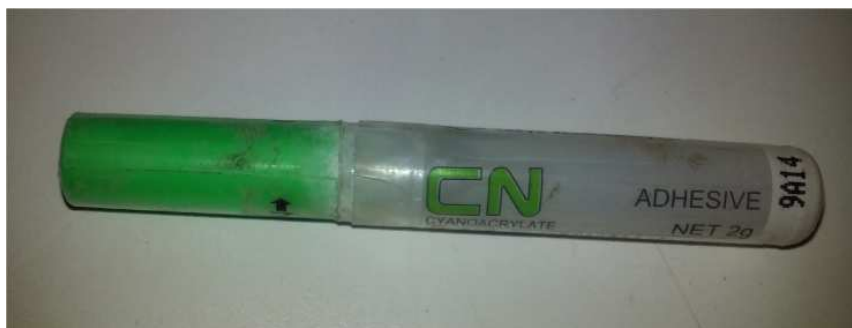
Figura 19. Cianoacrilat utilitzat per adherir la galga a la placa de formigó
