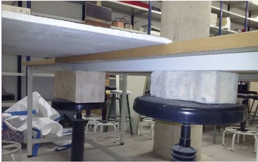
Figura 27. Suports per reforçar la taula i evitar deformacions paral·leles a les del panell
