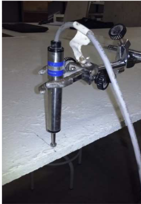
Figura 21. Transductor de moviment utilitzat als assaigs
