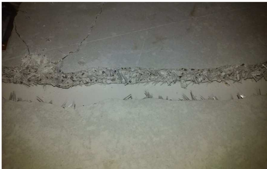
Figura 34. Detall fibres en la zona de ruptura
