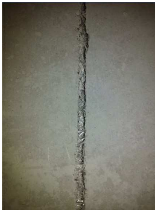
Figura 44. Detall fibres en la zona de trencament del segon assaig
