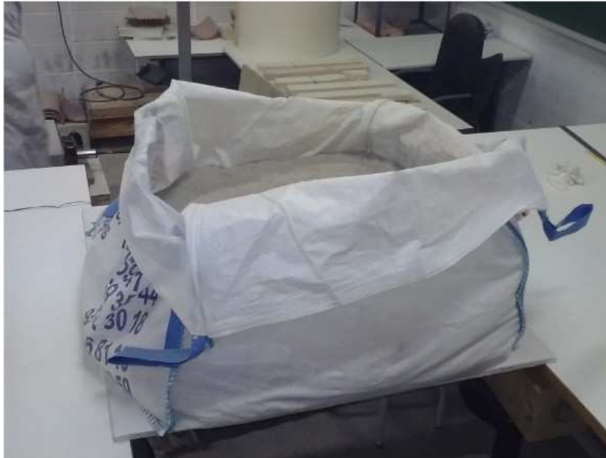
Figura 24. "Big-Bag" sobre el panell, carregat amb sorra
