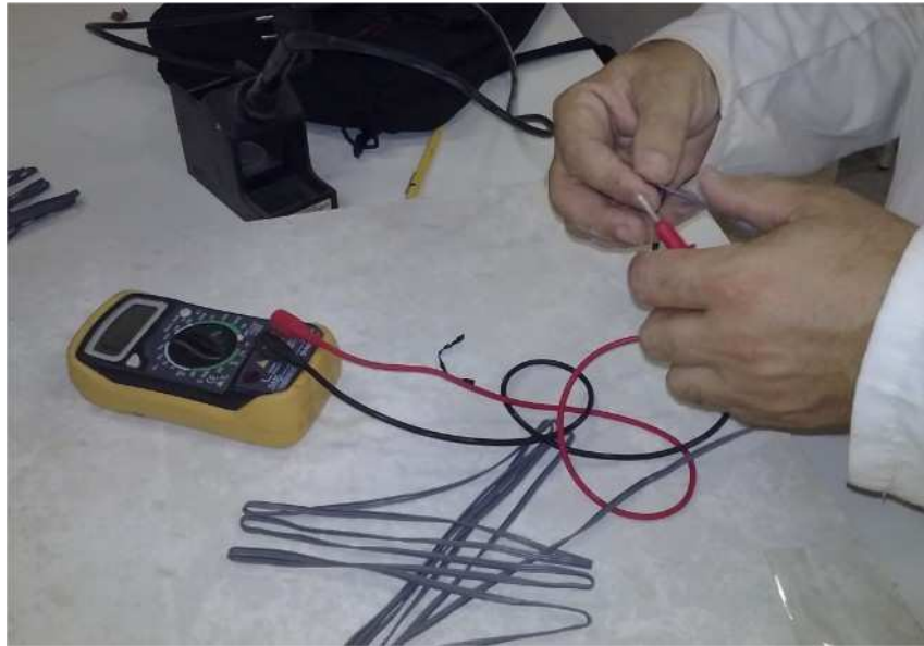
Figura 20. Comprovem amb el tester el correcte funcionament de les galgues
