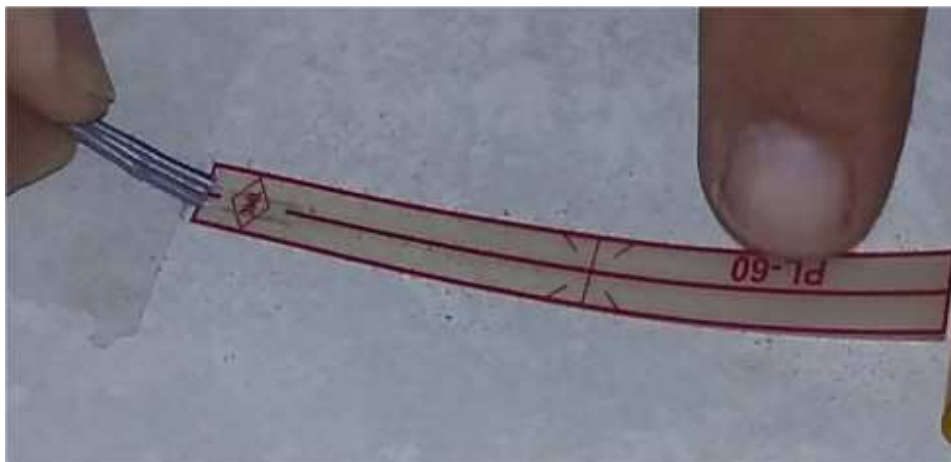
Figura 18. Galga unidireccional utilitzada en l'assaig
