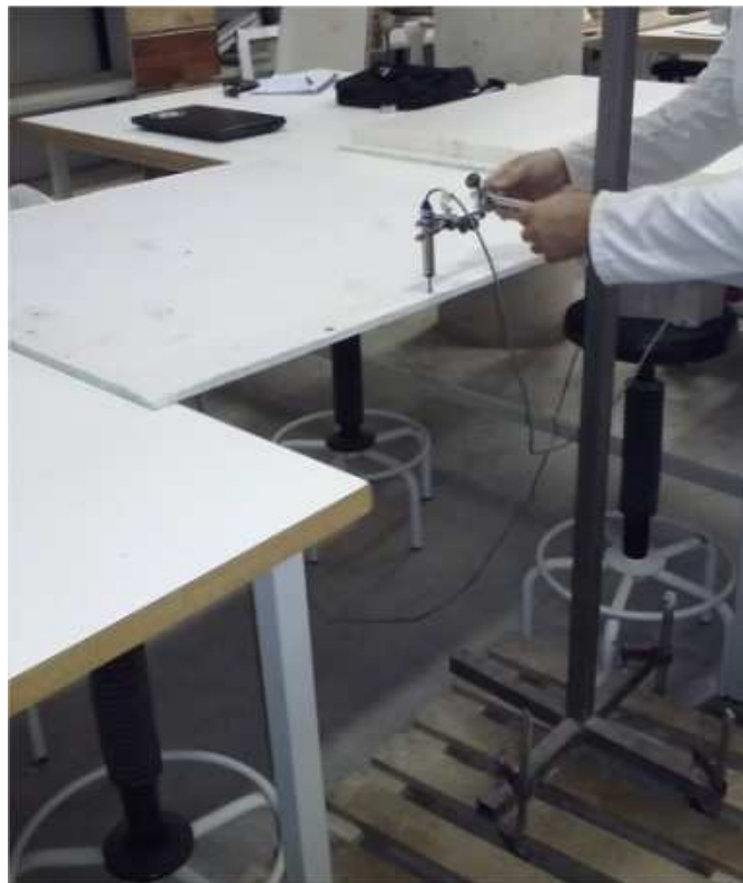
Figura 23. Col·locació transductor de moviment
