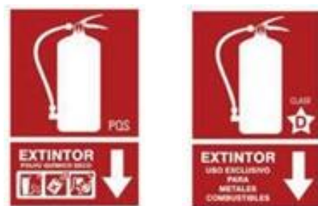
Figura 5. Extintor de pols química seca (PQS) per a focs de classe A,B i C (Figura esquerra). Extintor de pols especial per a metalls per a focs de classe D (Figura dreta).
