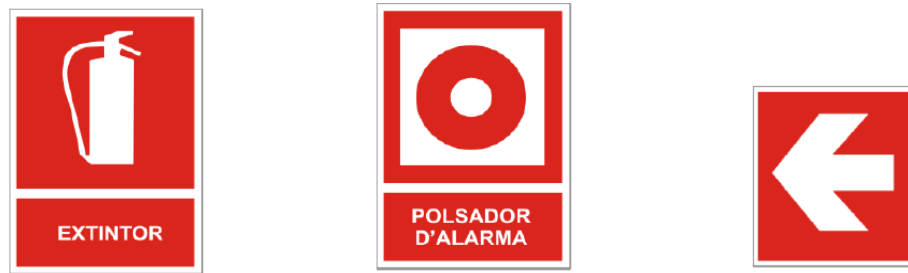
Figura 4. Senyals dels mitjans de protecció contra incendis utilitzats en l'establiment industrial. Figures d'esquerra a dreta. Senyal d'extintor, Senyal de polsador d'alarma i Senyal de direcció.
