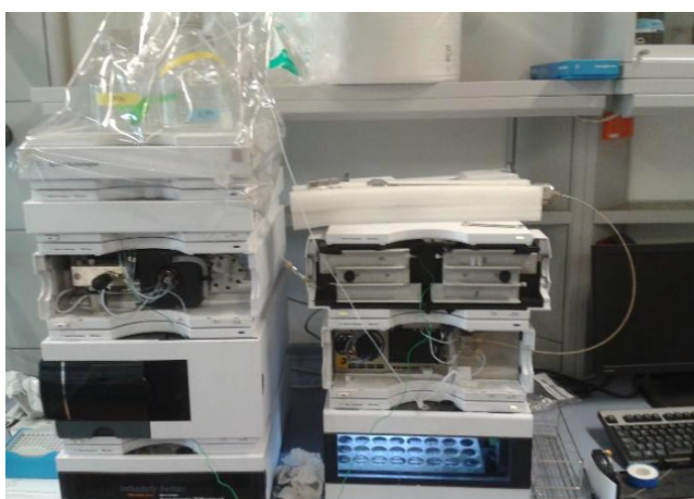
Fig. 3: Cromatógrafo de líquidos Agilent con columna GPC
