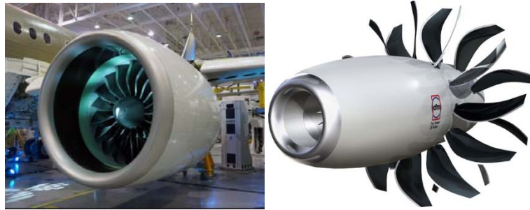
Il·lustració 1: A l'esquerra un motor tipus turbofan, a la dreta un motor tipus open-rotor.
