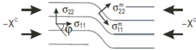
Il·lustració 74: Imperfecció de la alineació de les fibres [8].
