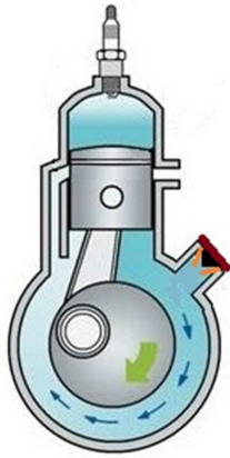
Fig. 93. Fase làmines obertes
