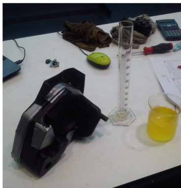
Fig. 14. Càlcul volum caixa filtre
