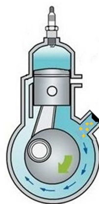
Fig. 96. Fase d'injecció ON
