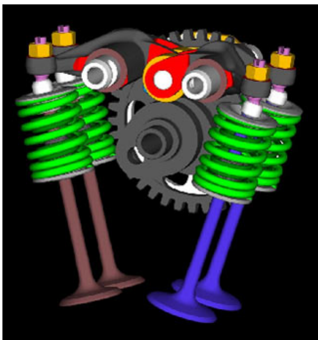
Figura 6.16c: Imatge generada per ordinador del sistema de distribució extret de l'interior del motor. En la figura es poden veure les vàlvules accionades per molles. Font bibliogràfica [b]
