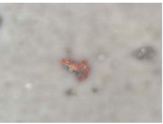
Partícula d'òxid de ferro. Segurament ha entrat aigua en el càrter
