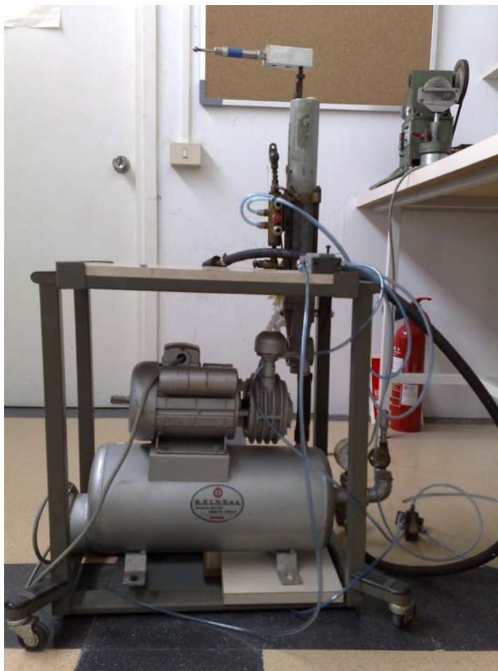
Fig. 14: Fotografia de l'aparell amb la bomba de succió afegida.
