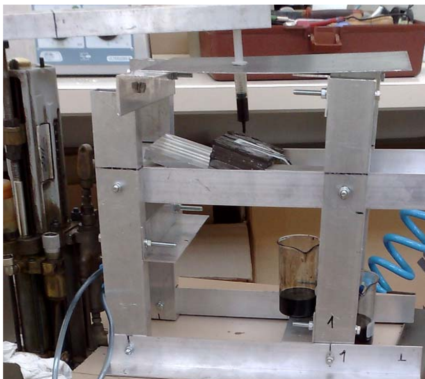
Fig. 17.: Fotografia de la tapa situada sobre el suport. Es pot observar com la xeringa hi queda travada dins.
