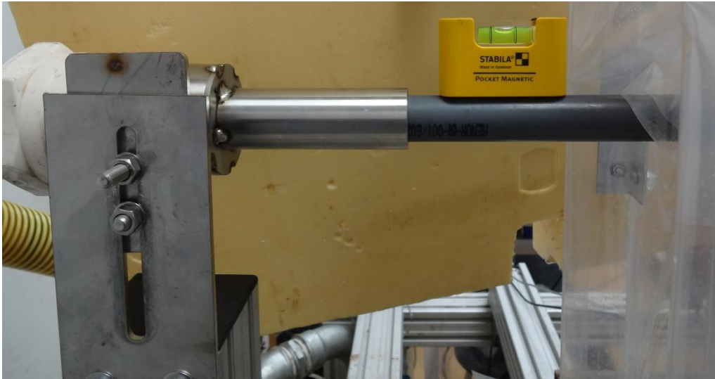
Figura 16. Càlculs per ajustar l'alçada del doll d'aigua, i posicionament a nivell.
