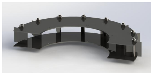
Figura 3. Mitja lluna del rodets de la turbina.
