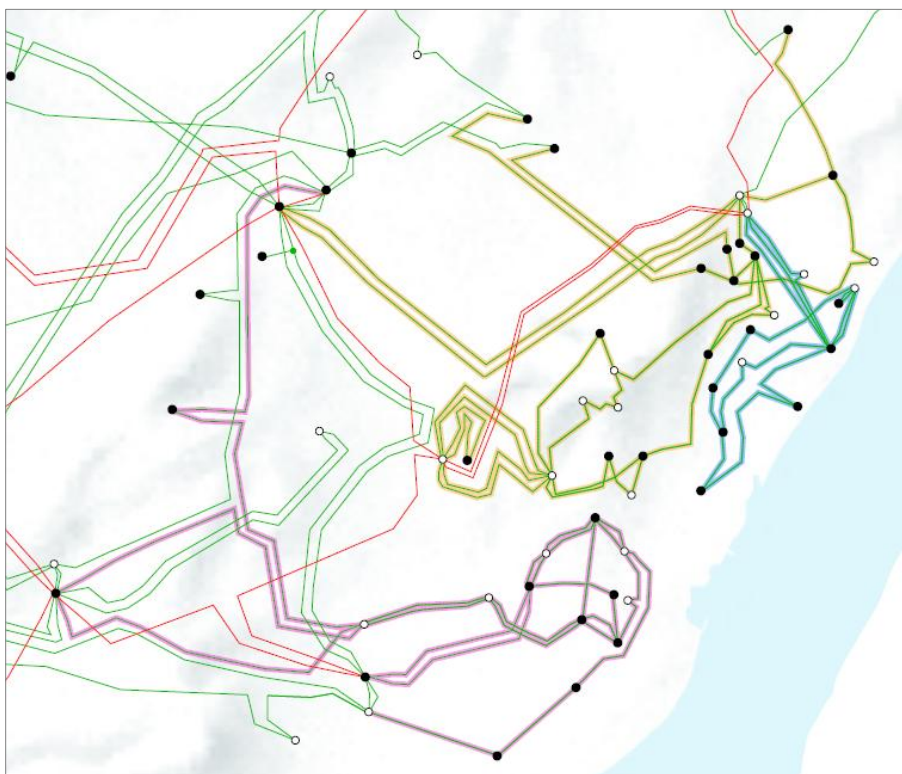
Figura 5.7. Configuració en tres subsistemes de la xarxa 220 kV de l'Àrea Metropolitana de Barcelona en servei a 1/1/2021, corresponents als colors rosa, groc i blau.
