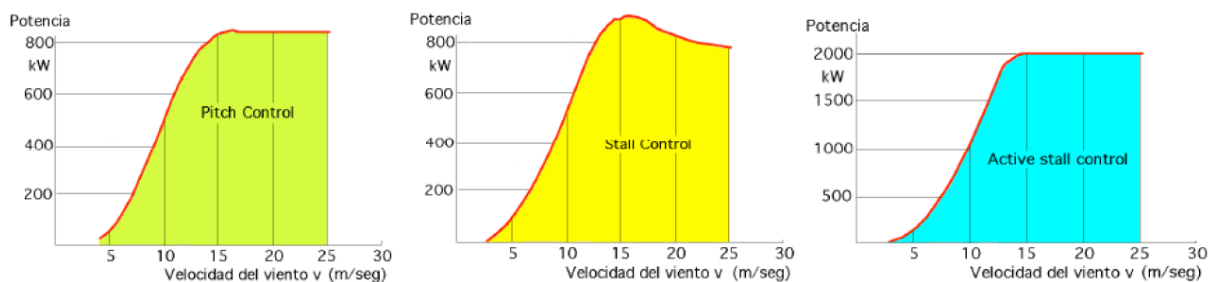
Figura 18. Corbes de potència per regulació, pitch, stall i pitch-stall
