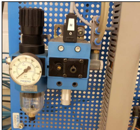
Figura 16. Imatge de la vàlvula general d'aire comprimit H
