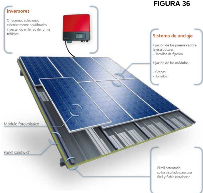
FIGURA 36 : Panell sàndwich amb integració de mòduls fotovoltaics.
