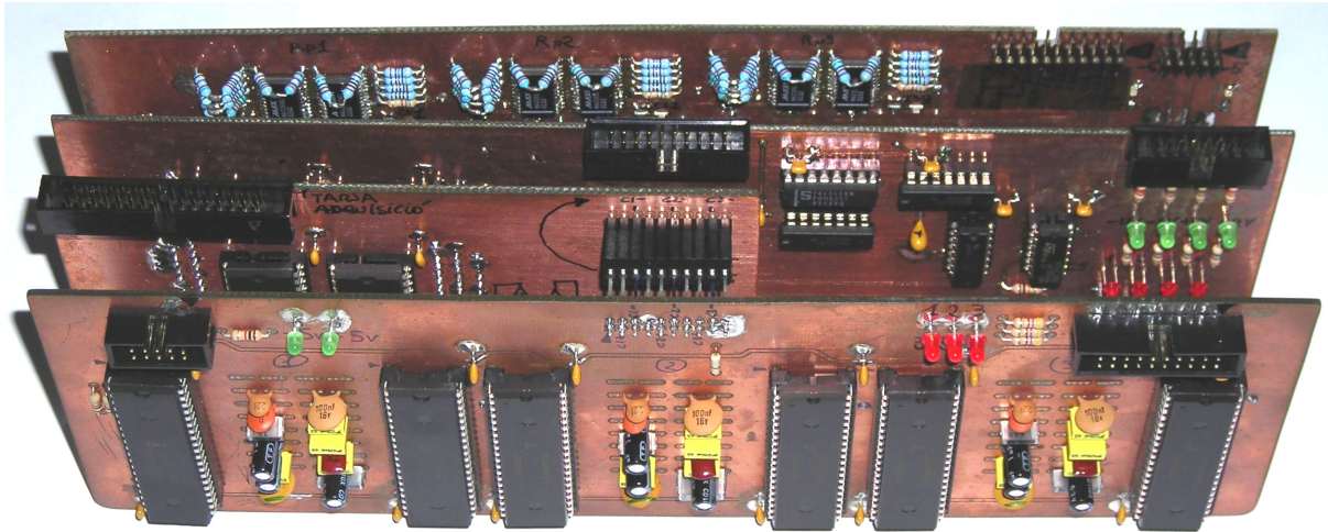
Figura 62. Plaques de circuit imprès que componen el CARdi.
