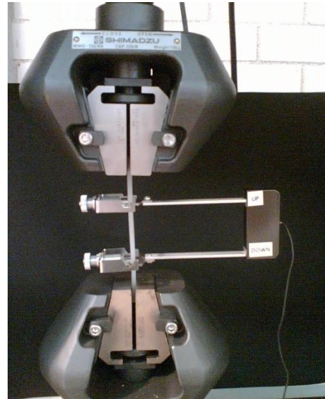
Figura 5.4. Imatge de l'extensòmetre utilitzat en els assajos mentre es realitzava un assaig.
