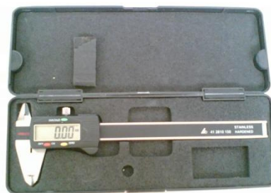
Figures 6.3 i 6.4. Micròmetre i peu de rei utilitzats per mesurar les provetes.
