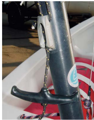
Figura 25. Sistema de regulació de la perxa
