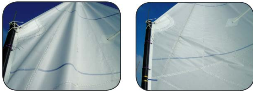
Figura 31. Plecs a la vela causats per la tensió de la perxa
