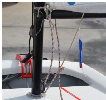
Figura 26. Sistema de contra d'un Optimist
