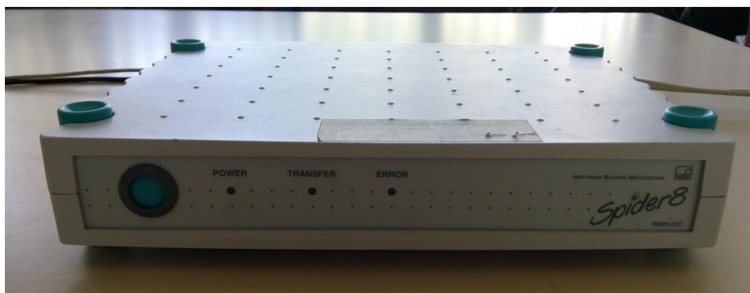
Figura 157: Adquiridor de dades Spider 8 (HBM, Alemanya)
