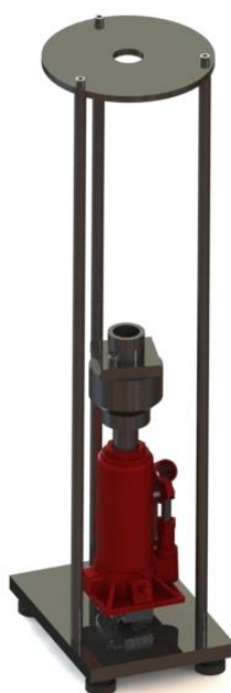
Figura 20: Muntatge assaig experimental amortidor
