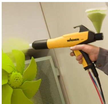
Figura 148: Pistola electrostàtica per aplicar pintura en pols
