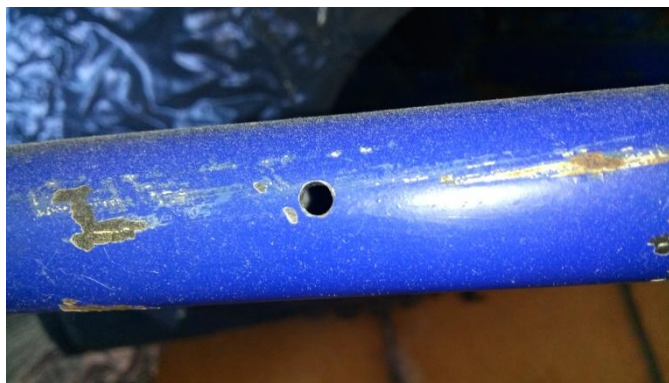
Figura 60: Forat amb el trepant per obtenir l'espessor
