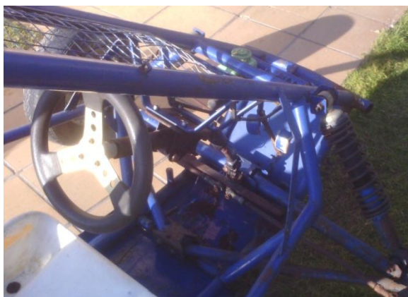
Figura 54: Sistema de direcció monoplaça preliminar
