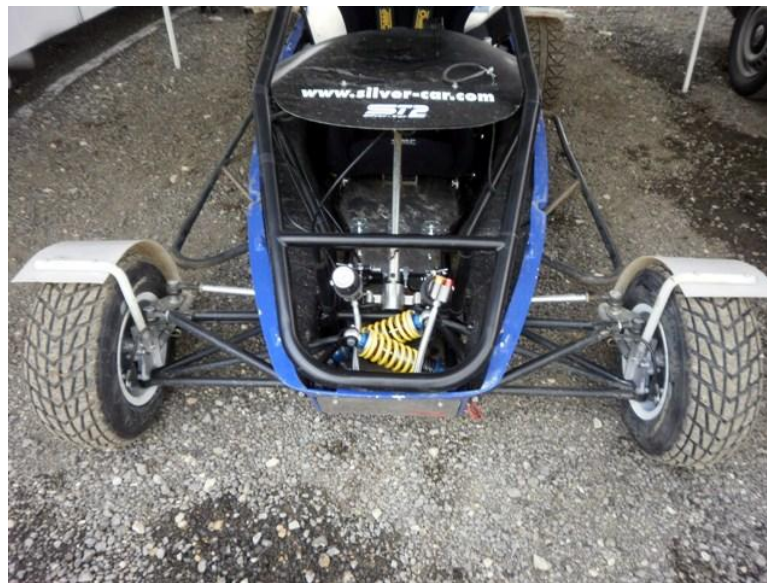
Figura 45. Detall de les suspensions de Silver Car
