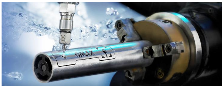
Figura 137: Tall de tubs per doll d'aigua
