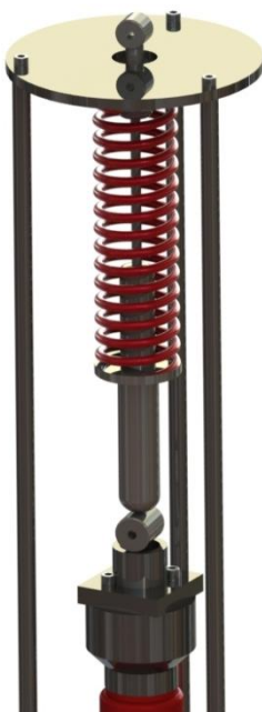
Figura 151: Subjecció part superior amortidor
