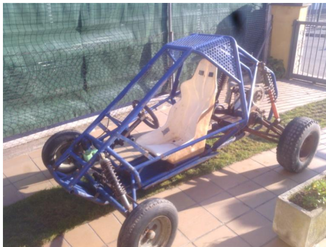
Figura 56: Xassís tubular monoplaça preliminar
