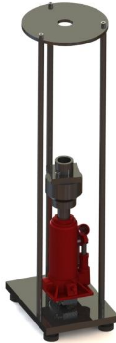
Figura 149: Gat hidràulic amb l' utillatge de suport
