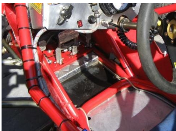
Figura 127: Detall constructiu subjecció pedalària
