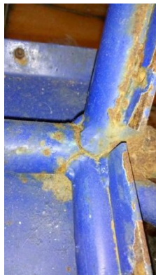
Figura 5: Estat soldadura unió de tubs xassís
