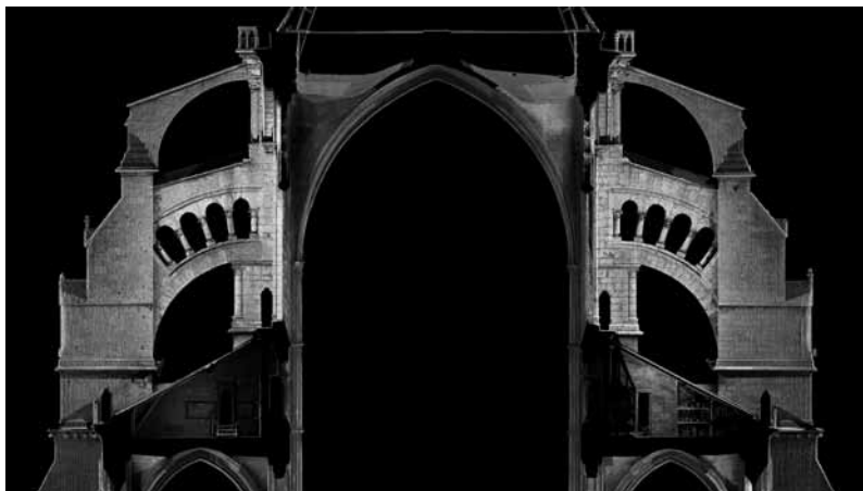
8. Coupe transversale de la nef de la cathédrale de Chartres à partir d'un relevé laser (détail).
