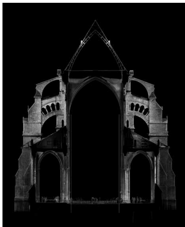
6. Coupe transversale de la nef de la cathédrale de Chartres obtenue par relevé laser en juin 2011, avec lignes verticales indiquant l'aplomb.
