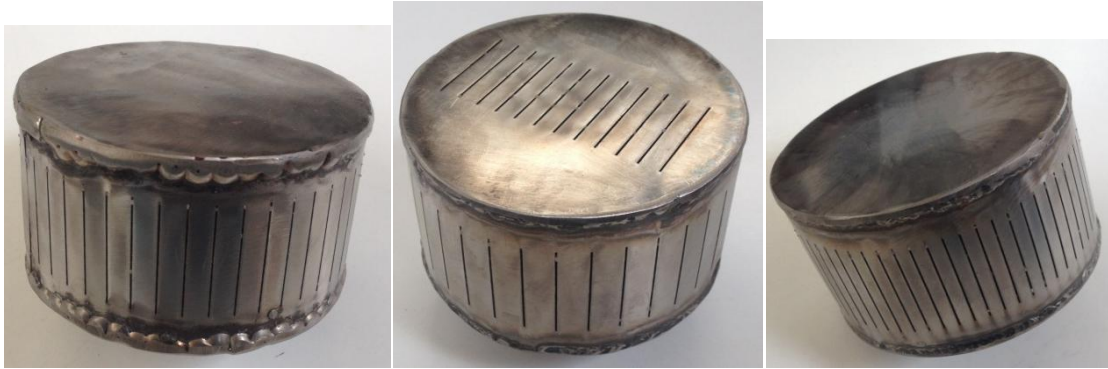
Figura 2. Imatges de les tres crepines fabricades i assajades. Es pot observar les diferents amplades entre escletxes i configuracions. Esquerra: crepina cilíndrica d'igual àrea de pas que la comercial; centre: crepina cilíndrica d'igual àrea de pas que la comercial amb escletxes a la tapa; dreta: crepina cilíndrica d'àrea 40% més que la comercial.
