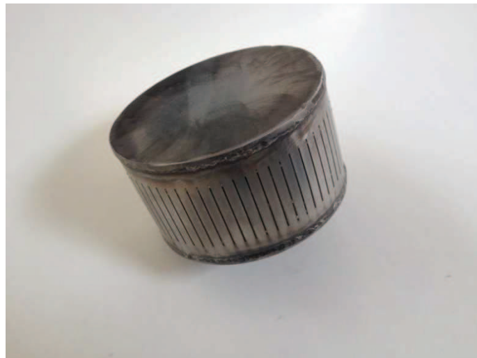
Figura 13. Crepina C on s'observa que les esclertes estan més juntes en la superfície lateral que en les crepines 1 i 2 i amb una tapa superior sense esclertes. Per a totes les crepines, la mida de cada esclerta és idèntica a la de la crepina comercial.
