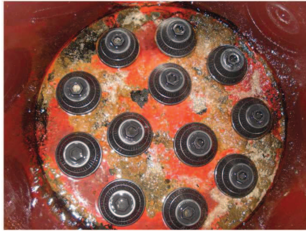
Figura 2: Imatge de l'interior del llit de sorra d'un filtre comercial amb varies crepines comercials instal·lades. Imatge extreta de G. Arbat et al. (2011).
