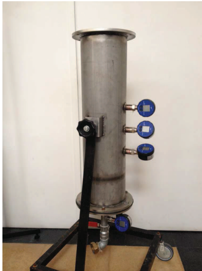
Figura 1. Filtre de sorra del laboratori de l'EPS que s'utilitza per assajos de pèrdues de càrrega.
