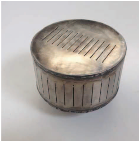
Figura 12. Crepina B amb escletxes al cos del cilindre i escletxes a la tapa superior.
