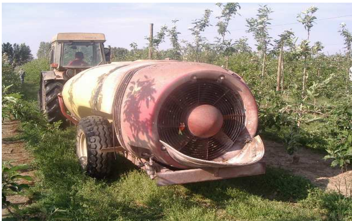
Figura nº 15 : Imatge de l'atomitzador (arrastrat per un tractor), emprat en tots els assajos d'aclarida química, a l'Estació Experimental Agrícola Mas Badia, durant el període 2000 – 2006 per l'aplicació dels aclaridors químics.
