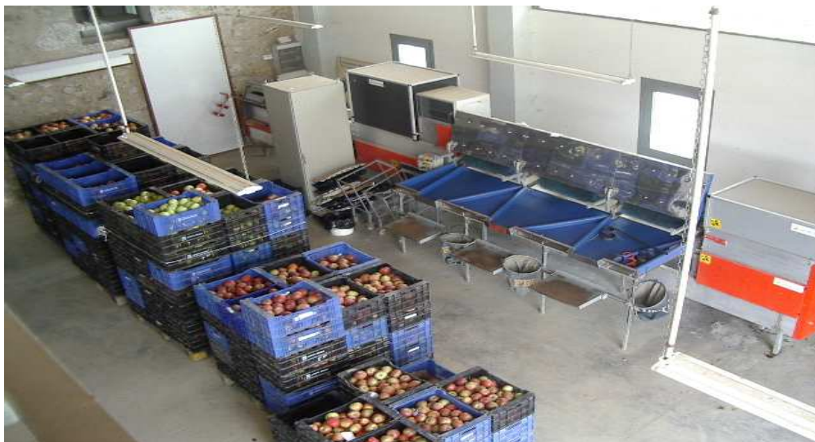
Figura nº 27: Imatge captada el 15/09/2007 de la calibradora marca CAUSTIER que es va emprar per la calibració dels fruits recol·lectats. Aquesta calibradora mesurava el calibre de cada fruit realitzant una distribució de calibres, la coloració i el pes total (Kg) dels fruits de cada arbre control que es van recol·lectar per separat en caixes.
