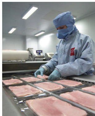
Figura 4: Operari que col·loca les porcions de producte a la màquina termoformadora perquè siguin envasades.
