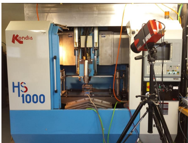
Figura 2.6 Centre de mecanitzat Kondia® HS-1000 i càmera termogràfica
