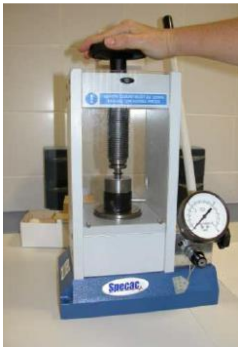
Figura 41 - Foto del conformador de pastilles dins de la premsa
