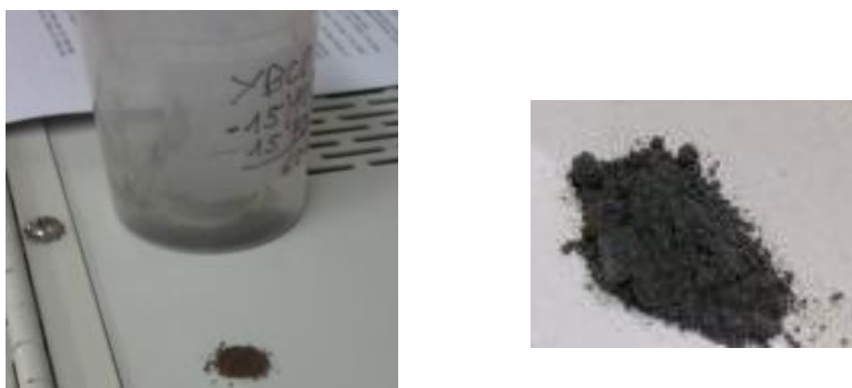
Figura 32 - Fotos de les pólvores obtingudes un cop s'ha tractat la dissolució a 400 °C
