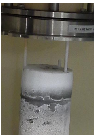
Figura 33 - Foto dels dos tubs, situats a la dreta, del forn d'alta temperatura per on surt i entra el gas argó
