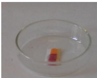
Figura 30 - Paper indicador. El color vermell indica un medi molt àcid
