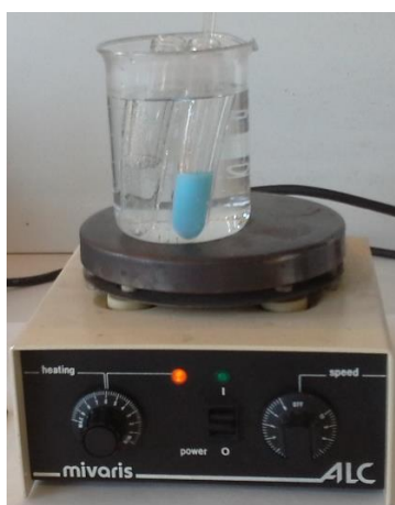
Figura 29 - Foto de les dissolucions escalfades en la placa calefactora a 60 °C
