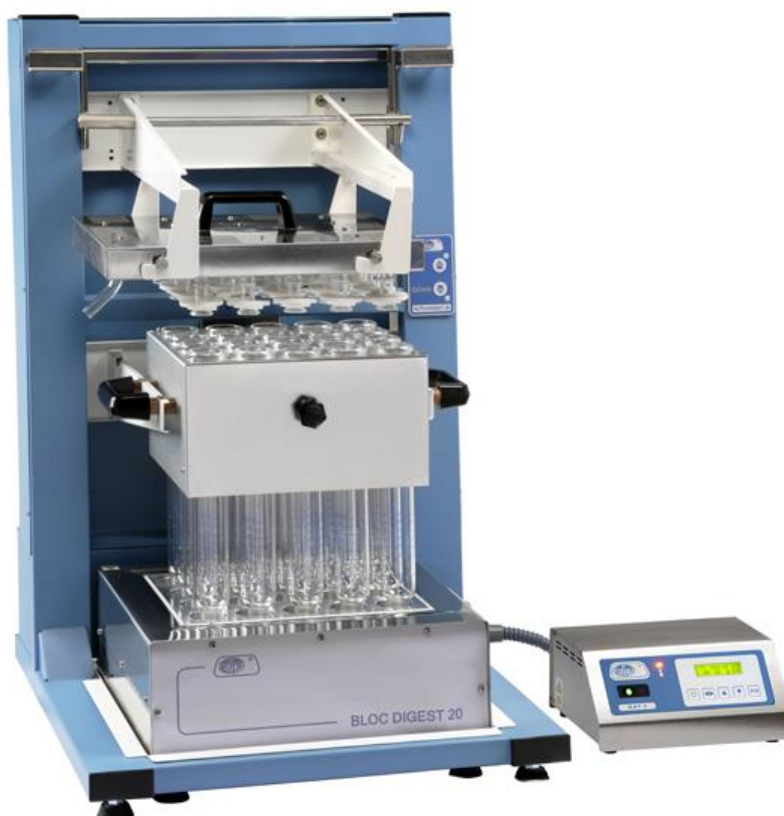
Figura 12 - Imatge del forn Kjeldhal
