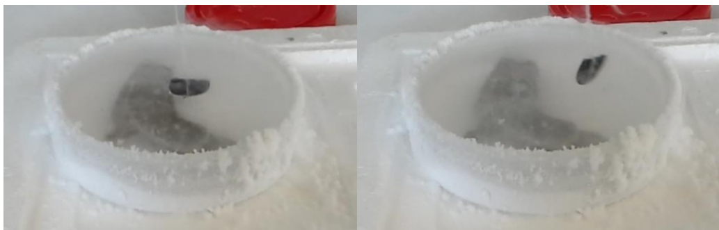
Figura 77 - Foto del superconductor levitant en refredar-se en nitrogen líquid
