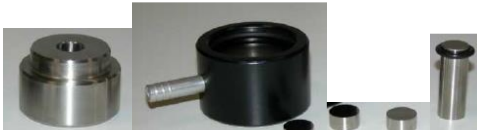
Figura 38 - D'esquerra a dreta: cos del conformador, base resistent per a facilitar el premsat, cilindres petits d'acer i èmbol cilíndric encarregat de transmetre pressió a la pols
