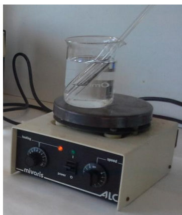
Figura 27 - Foto de la dissolució de PEG escalfant-se a la placa calefactora a 60 °C
