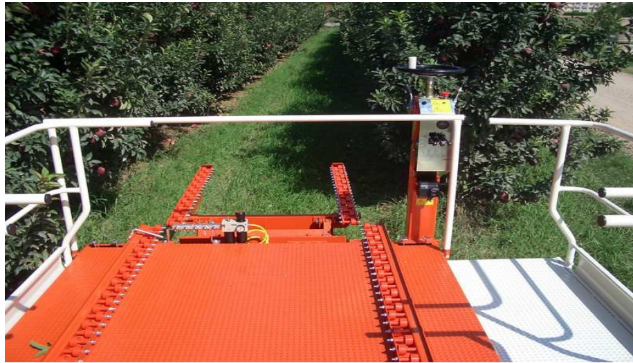
Figura 1. Distribució de les plataformes de treball en una màquina recol·lectora de fruits. La secció de color blanc és on actua l'operari
