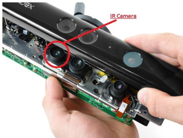
Figura 10: Sensor de profunditat IR de Kinect
