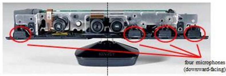
Figura 12: Set de 4 micròfons del sensor Kinect
