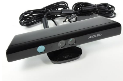
Figura 8: Connector USB i adaptador de corrent Kinect
