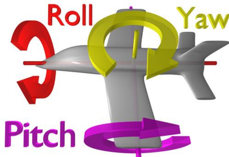
Figura 2.2: Roll, Pitch i Yaw d'una aeronau
