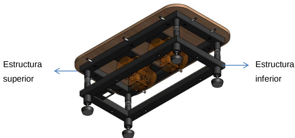
Figura 5: Parts de l'estructura que componen la màquina
