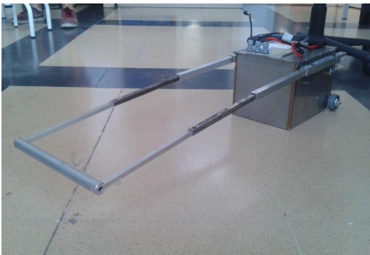
Figura 1. Muntatge complet de la bateria portable.
