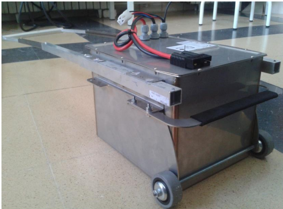
Figura 81. Muntatge complet de la bateria portable.
