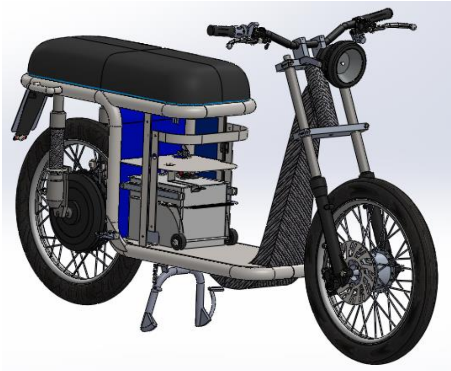
Figura 12. Posició de la bateria a la motocicleta amb el mànec plegat.
