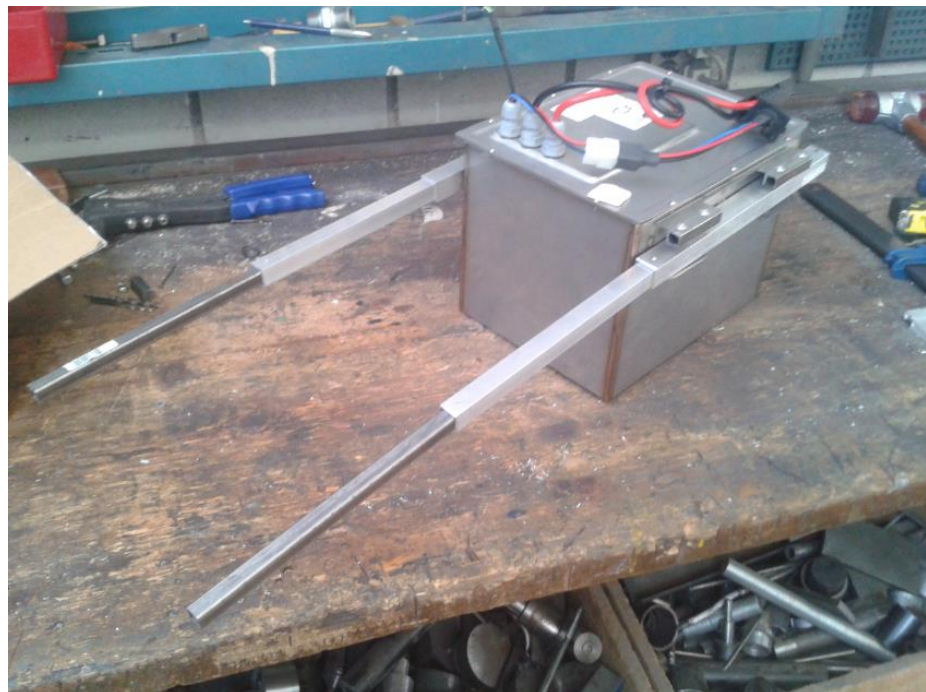
Figura 78. Muntatge del mànec extensible.
