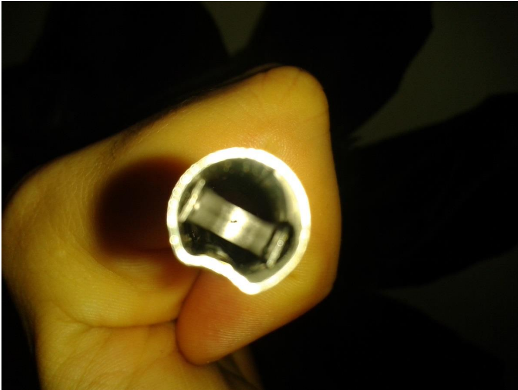
Figura 41. Ubicació de la molla a l'interior del tub.
