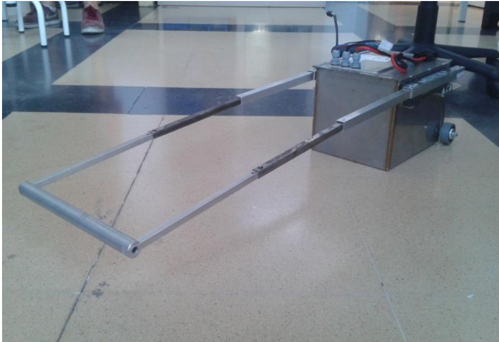
Figura 80. Muntatge complet de la bateria portable.
