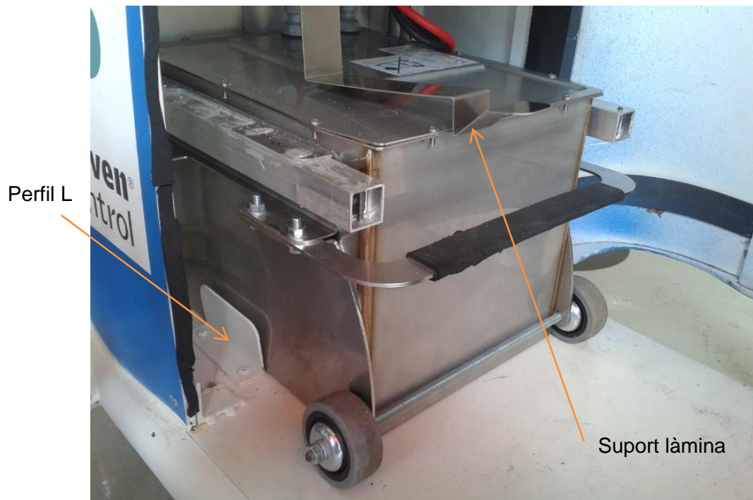
Figura 82. Detall d'un dels perfils "L" i el suport làmina.
