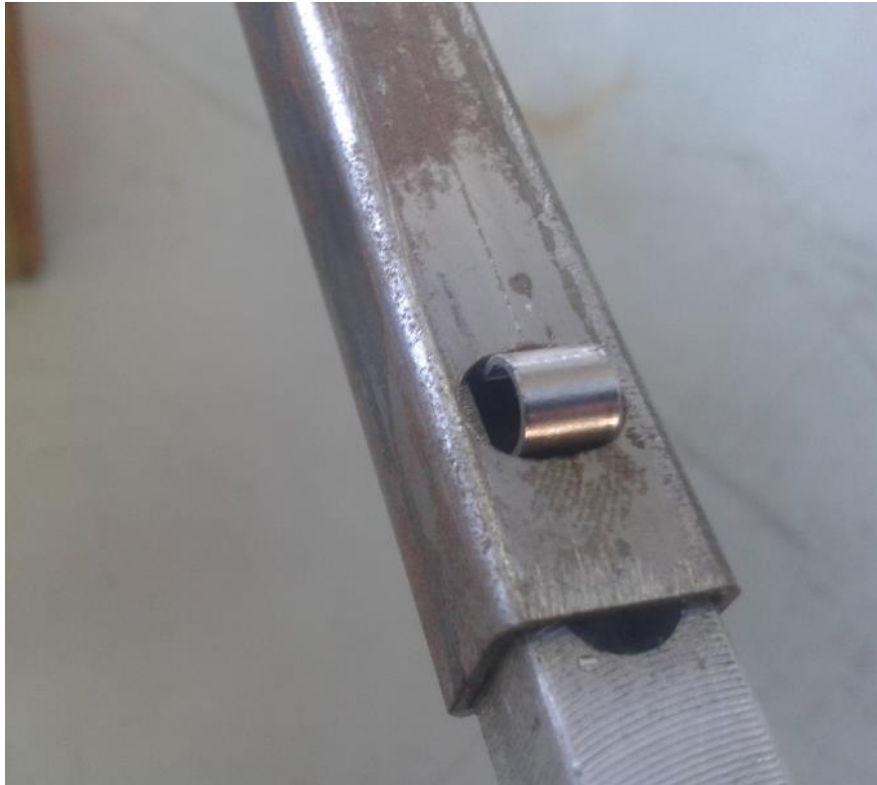
Figura 79. Detall de la molla de fixació a la seva ubicació.
