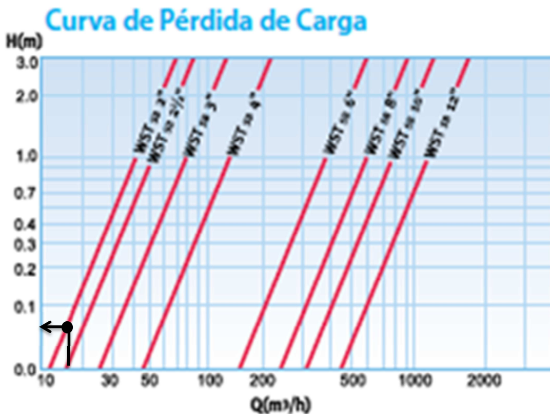
Figura 71. Gràfica de la pèrdua de càrrega del comptador volumètric
