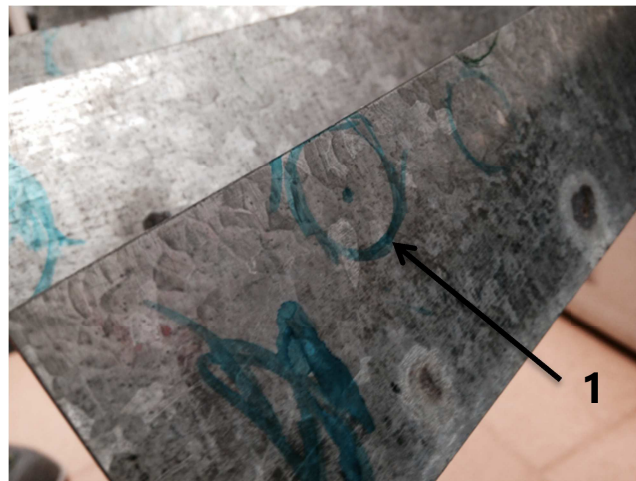
Figura 15. Dibuix del contorn del doll (<20mm) amb marca del seu centre (1)
