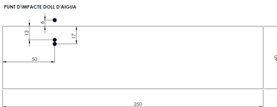
Figura 31. Croquis dels diferents punts d'impacte analitzats del doll respecte la part superior de l'àlep (cotes en mm)
