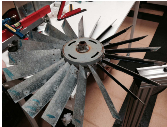
Figura 18. Conjunt del rodet reposat a la taula de treball per tal de fixar l'angle d'inclinació dels àleps ( \alpha ).
