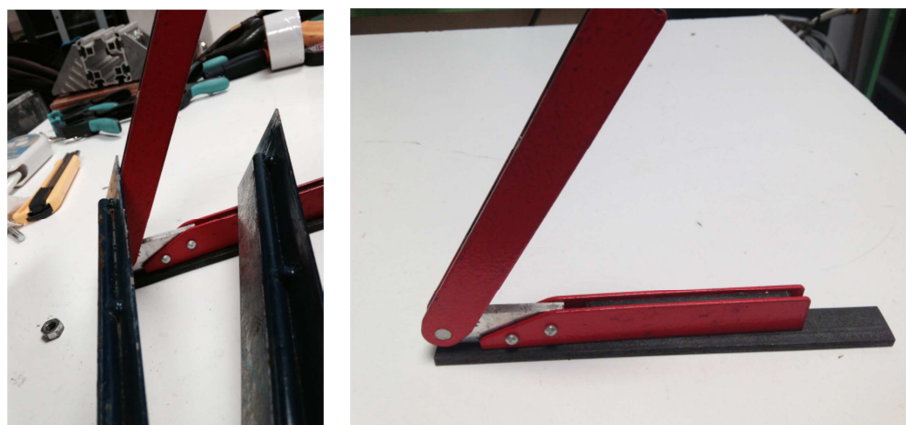
Figura 19. Ajustador d'angles amb imant incorporat
