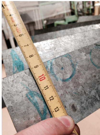
Figura 16. Mesura de la distància entre el punt central del doll i l'extrem superior de l'àlep. En aquest cas s'ha referenciat el (0) a la mida de (10), en aquest cas la mida marcada és de 11 mm respecte la part superior de l'àlep.
