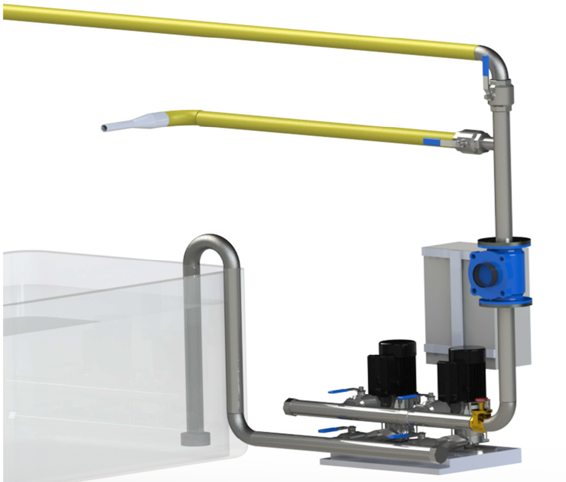
Figura 68. CAD 3D (renderitzat) de la instal·lació hidràulica
