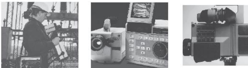
Conjunt fotogràfic 1: Càmeres termogràfiques pioneres del sector, de l'any 1964. Imatges extretes de la guia FLIR
