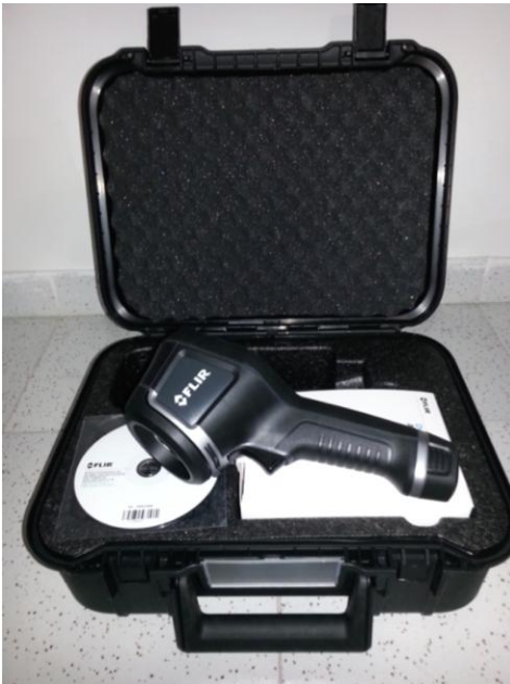
Conjunt fotogràfic 6: Càmera termogràfica FLIR E6 i els seus accessoris
