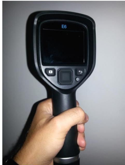
Conjunt fotogràfic 6: Càmera termogràfica FLIR E6 i els seus accessoris
