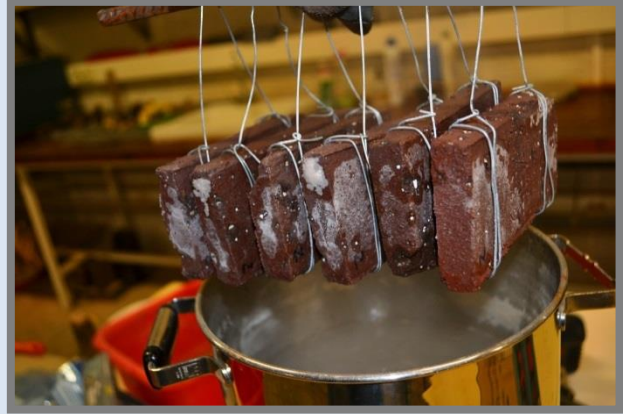
Extraient mostres cocció 2 de l'assaig d'absorció.
