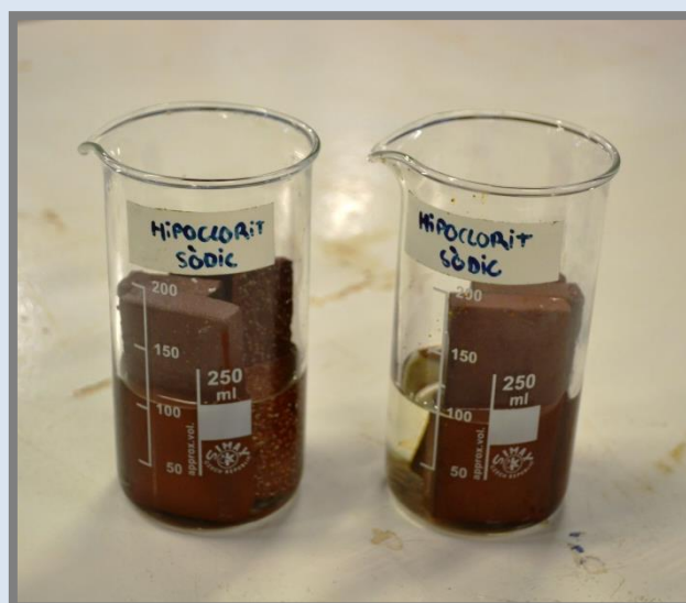
Mostres hipoclorit sòdic després dels 12 dies.
