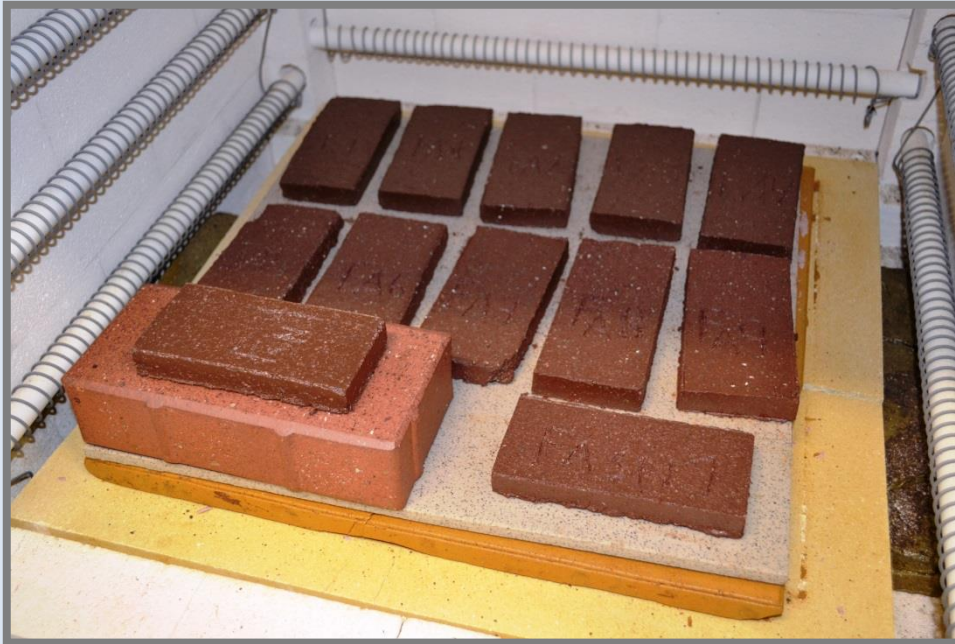
Mostres F1, FA1, FA2, FA3, FA4, FA5, FA6, FA7, FA8, FA9, FSN1 i FASN1 segona cocció cuites.
