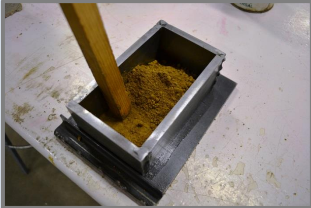
Premsar l'amassada amb un pal de fusta.
