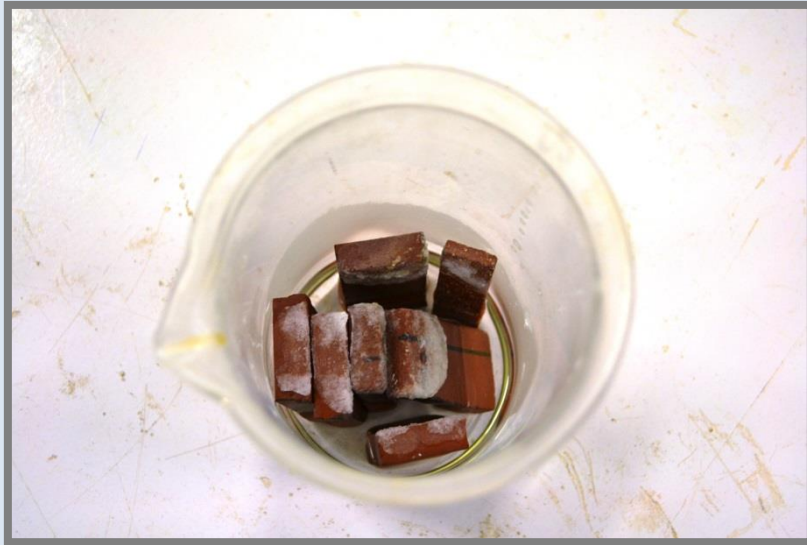
Mostres clorur amònic després dels 12 dies.
