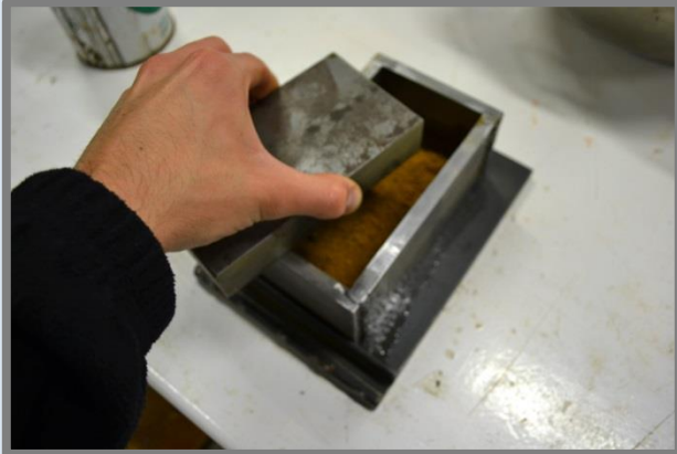
Introduint el suport superior a dins el motlle.
