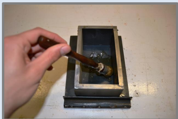
Motlle pintat amb oli desencofrant.
