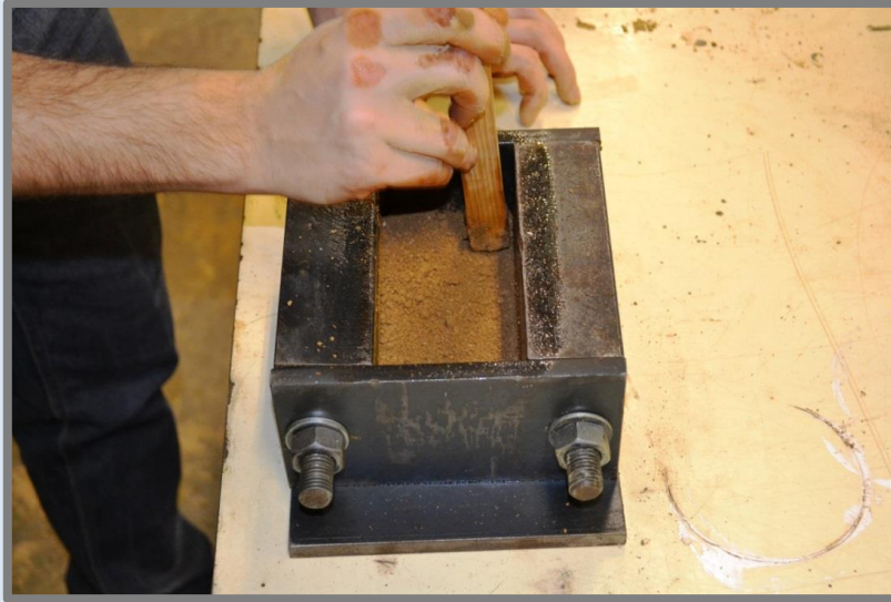
Premsar l'amassada amb un pal de fusta.
