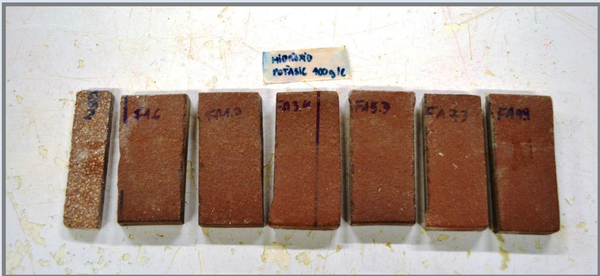
Mostres d'hidròxid potàssic de 100 g/l després de l'assecat amb l'estufa de dessecació.
