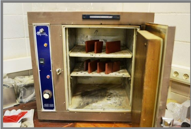
Assecant les mostres a l'estufa de dessecació.
