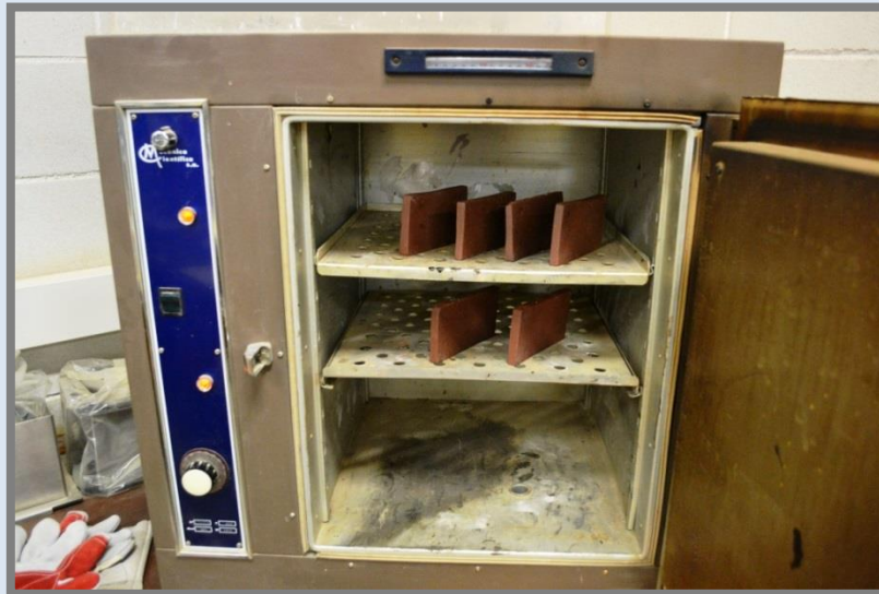
Estufa d'assecat amb les mostres a l'interior.
