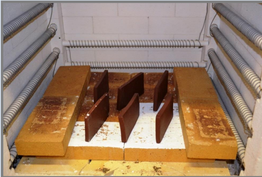
Mostres dins el forn per la recuita.
