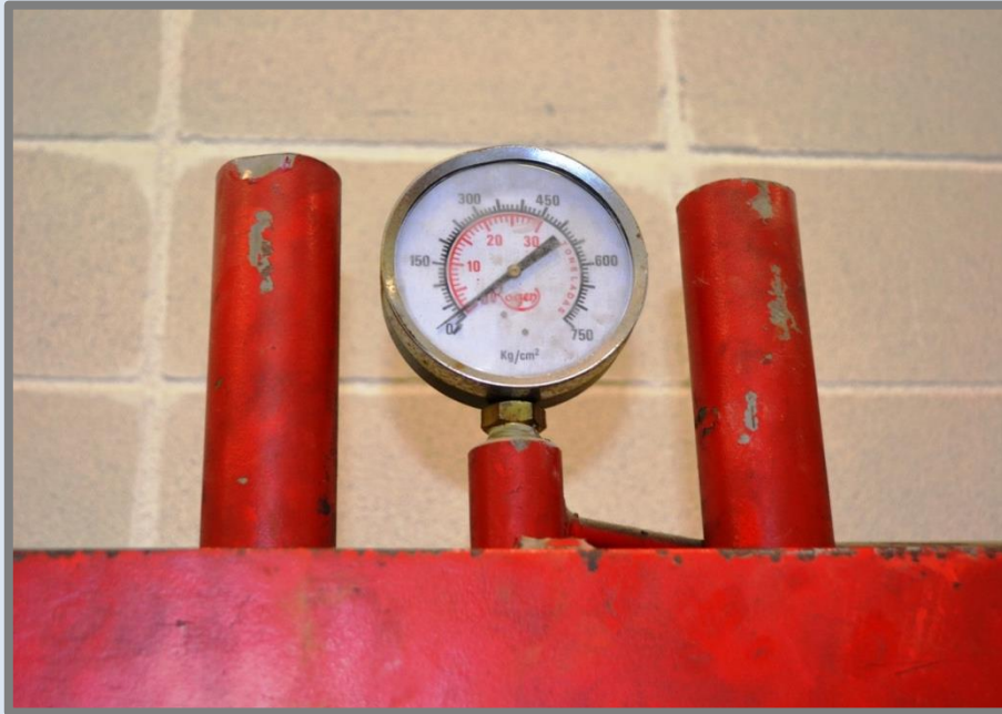
Manòmetre de la premsa hidràulica manual (premses a 2 \text{ kg/cm}^2 ).
