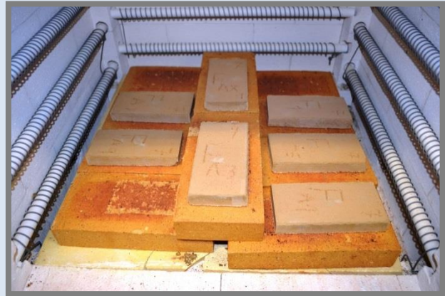
Mostres seques de la setena coccio al forn.
