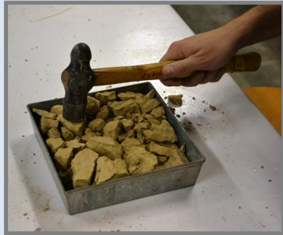
Trencant la "galleta" o capa de fang amb un martell.
