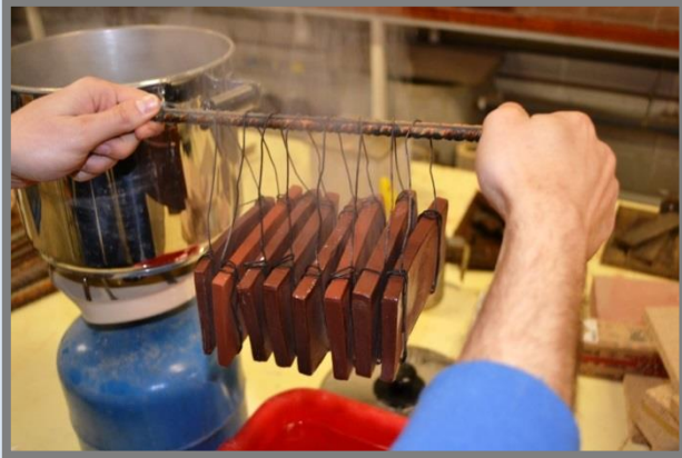
Introduint mostres a l'aigua a temperatura ambient.
