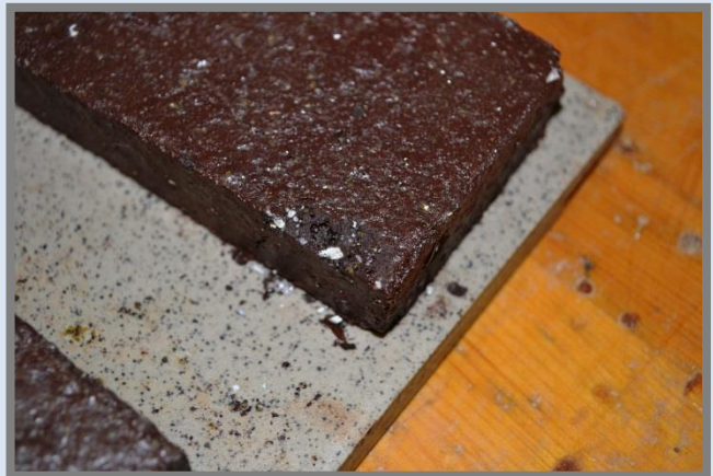
Mostres deteriorades a causa de la hidratació de la calç.
