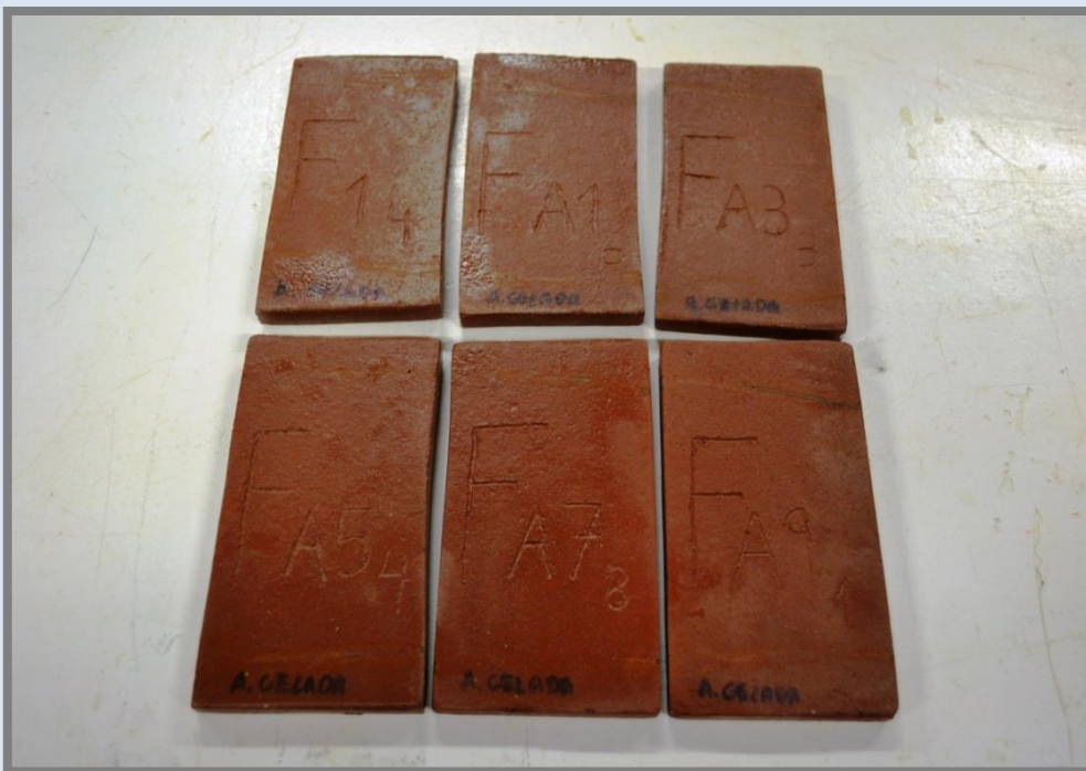
Mostres després dels 100 cicles de gel i desgel.
