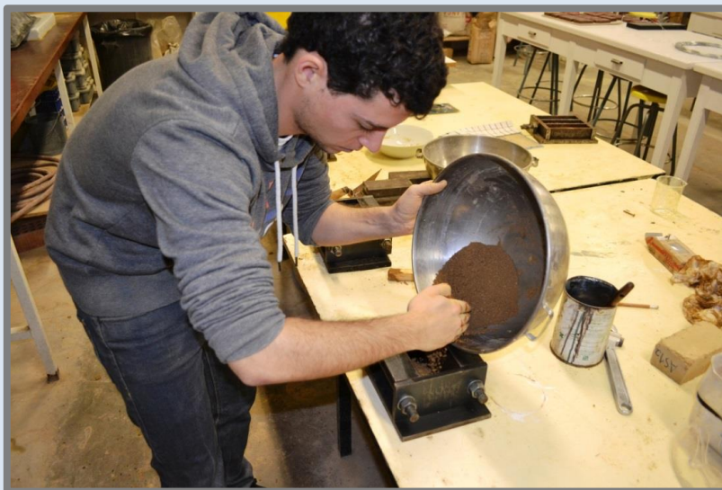
Introduint l'amassada dins el motlle de BTC.
