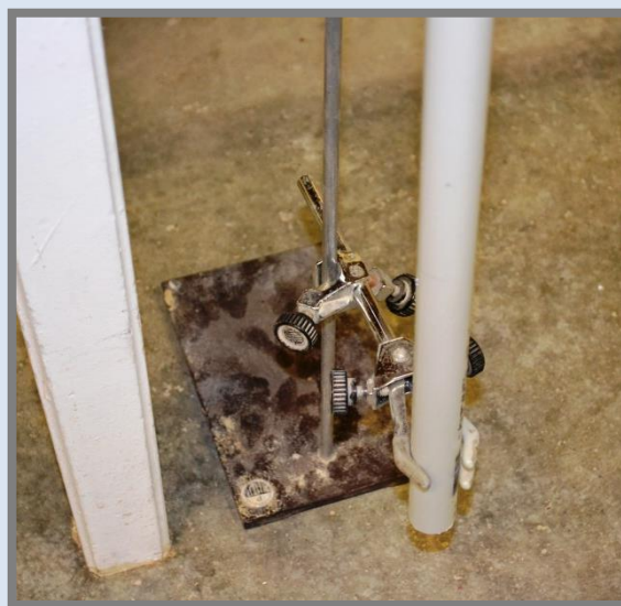
Equip llançador de la bola d'acer.
