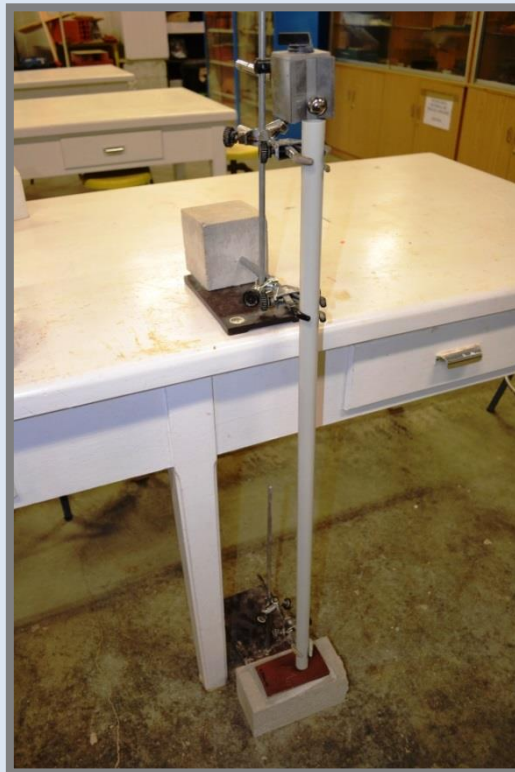
L'equip llançador de la bola d'acer amb la unitat d'assaig enganxada al bloc de formigó.
