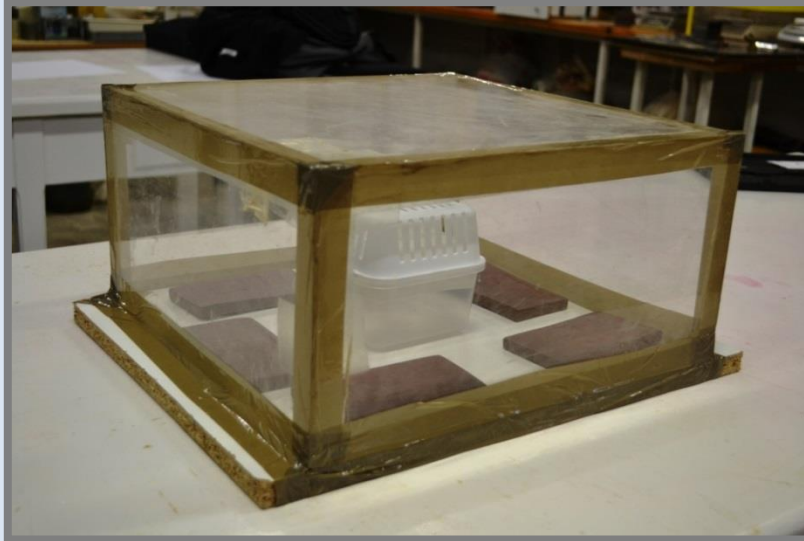
Dessecador de gel de sílice amb les mostres a l'interior.
