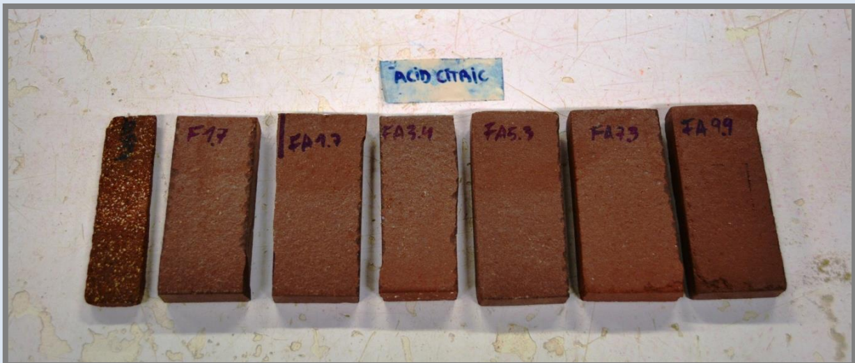
Mostres d'àcid cítric després de l'assecat amb l'estufa de dessecació.
