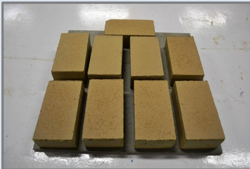
Mostres seques després d'estar a l'estufa de dessecació.
