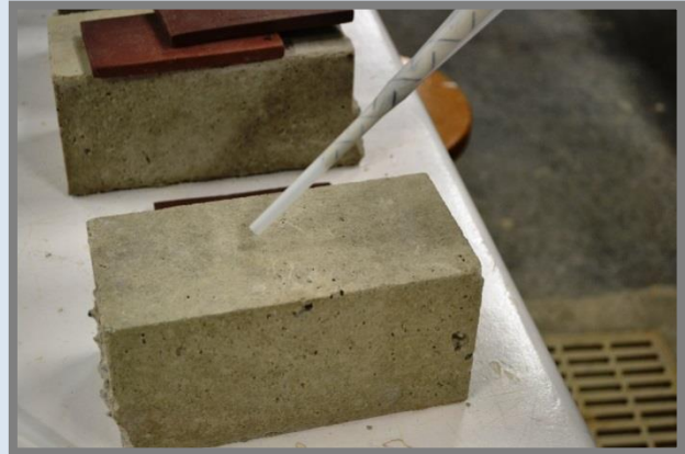
Bloc de formigó injectant la resina epoxi adhesiva.
