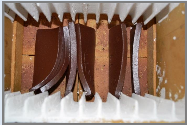
6 mostres de la vuitena cocció deformades a l'interior del "casset".
