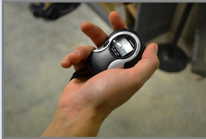
Cronòmetre per anotar l'interval de temps entre el primer i el segon rebot.
