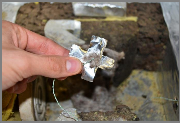
Cinta adhesiva d'alumini amb la llana natural i la connexió dels termoparells.
