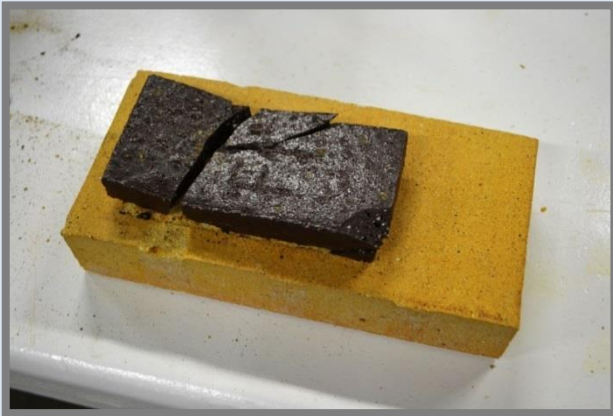
Mostra F1 enganxada al suport refractari.
