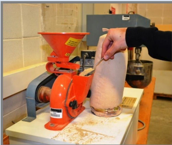
Introduint el fang esmicolat al molinet picador.
