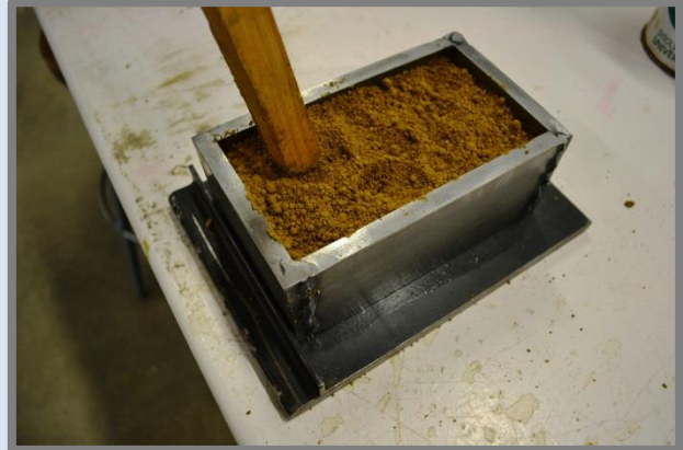
Premsar l'amassada amb un pal de fusta.
