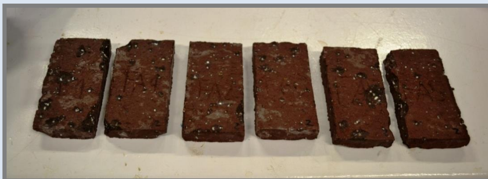
Mostres cocció 2 després d'assaig d'absorció.
