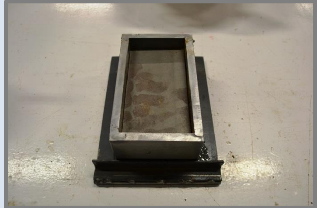
El motlle amb l'amassada a l'interior, abans de premsar.
