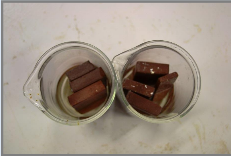
Mostres hipoclorit sòdic després dels 12 dies.
