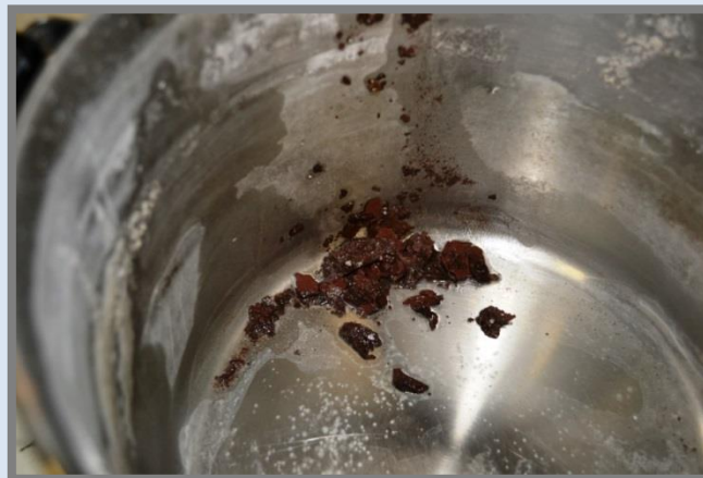
Pèrdua de material de les mostres de la cocció 2.
