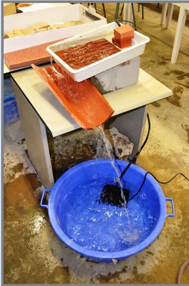
Mecanisme creat per sotmetre les mostres a l'acció d'aigua corrent.
