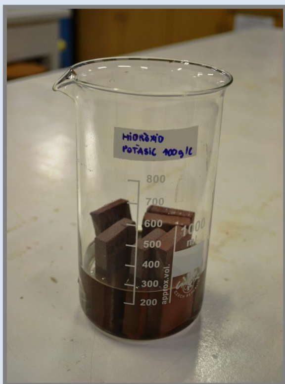
Mostres hidròxid potàssic de 100 g/l abans dels 12 dies.
