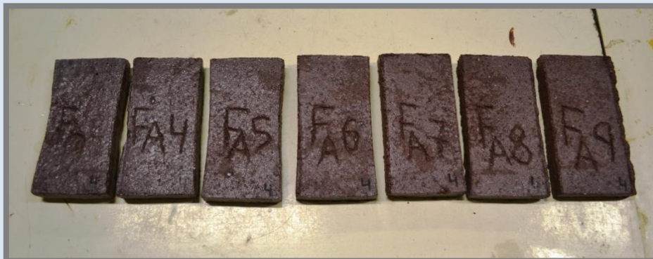
Mostres cocció 4 després d'assaig d'absorció.
