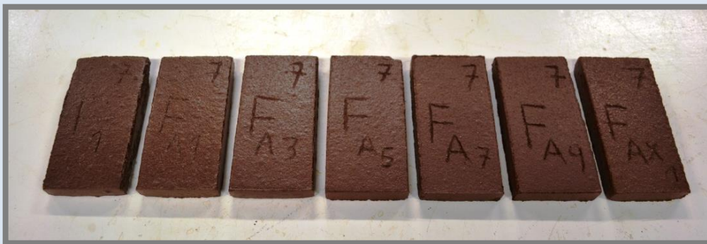
Mostres de la setena cocció cuites amb l'escala de dosificacions.
