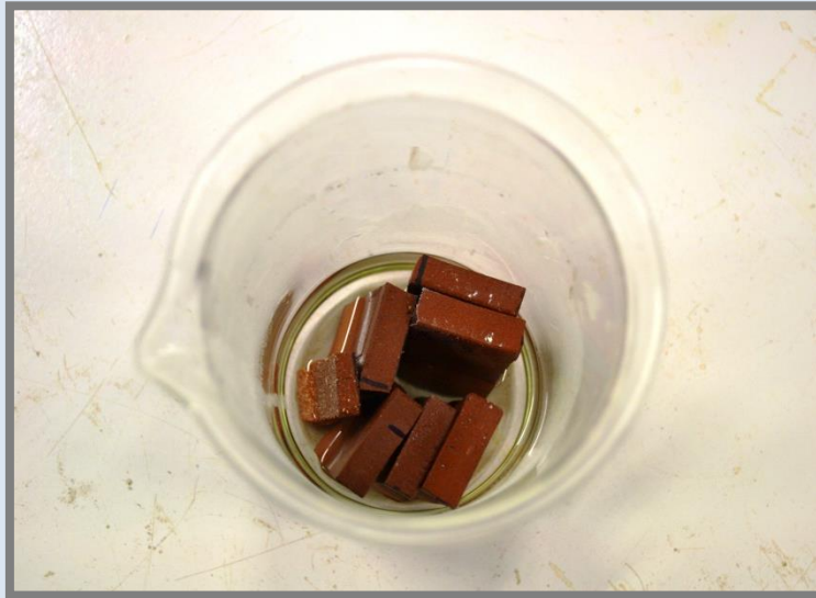
Mostres hidròxid potàssic de 100 g/l després dels 12 dies.
