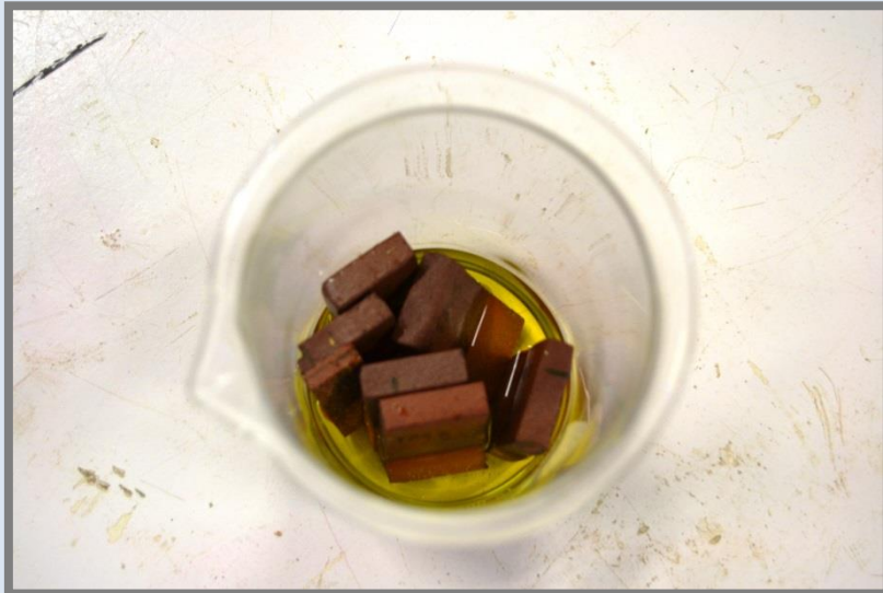
Mostres d'àcid clorhídric al 3% després dels 12 dies.
