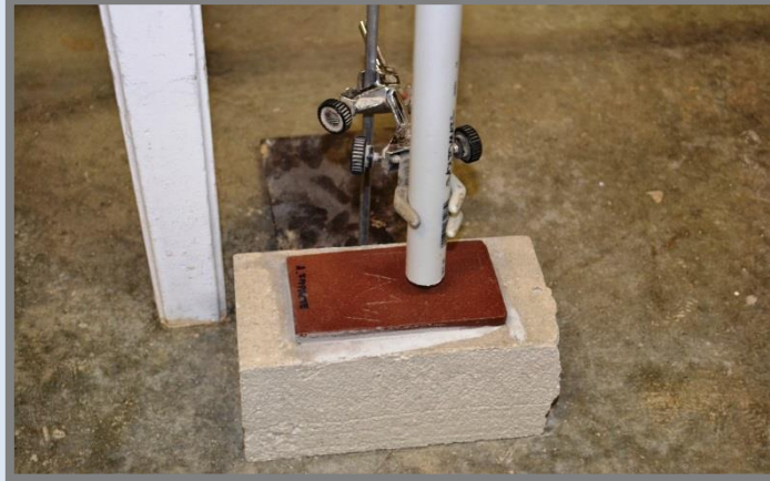
La unitat d'assaig amb el bloc de formigó sota l'equip llançador.
