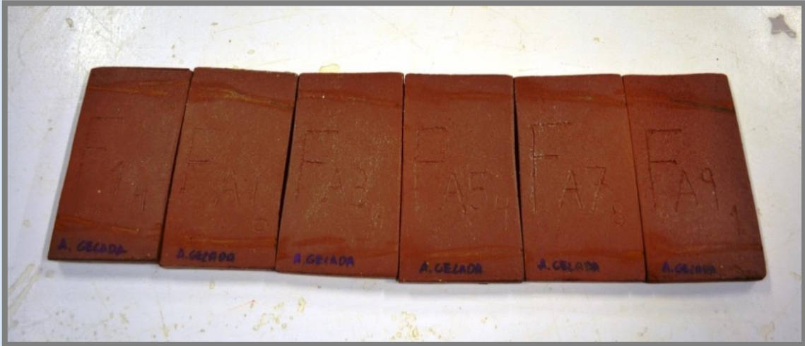
Mostres després de l'assaig d'absorció.
