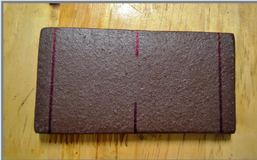
Mostra marcada amb distàncies entre els punts de recolzament.
