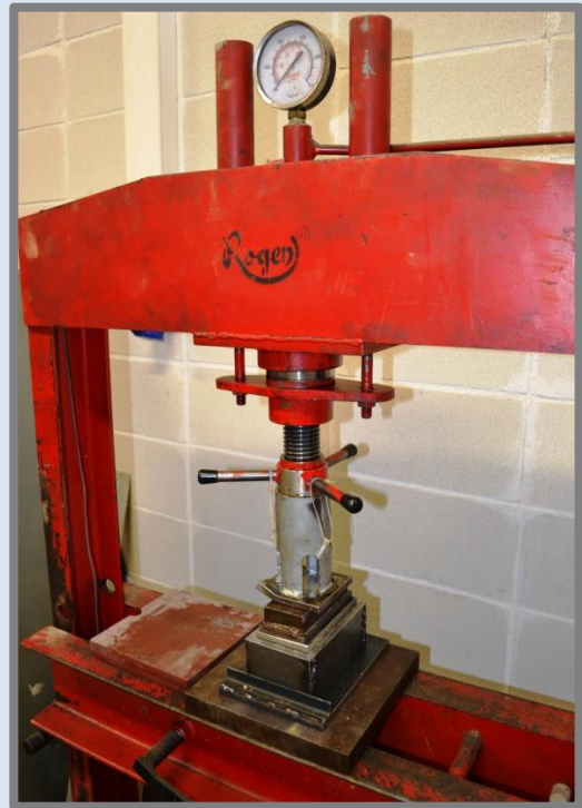
Motlle amb l'amassada a la premsa hidràulica manual.
