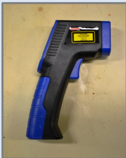
Detector tèrmic per infrarojos per mesurar la temperatura.
