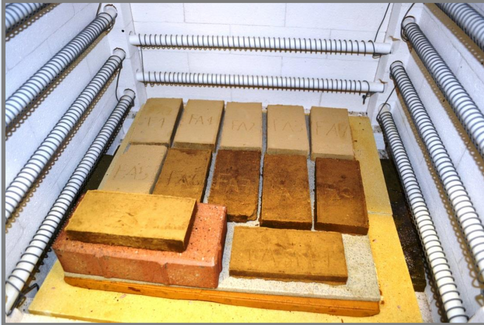
Mostres F1, FA1, FA2, FA3, FA4 i FA5 seques i mostres FA6, FA7, FA8, FA9, FSN1 i FASN1 humides de la segona cocció sense coure.
