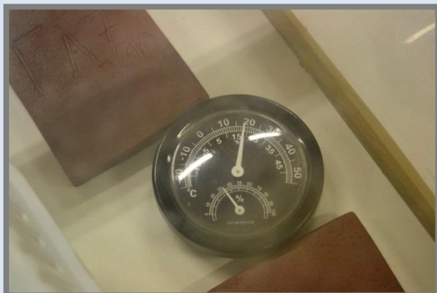
Higròmetre al interior del dessecador (32% humitat).
