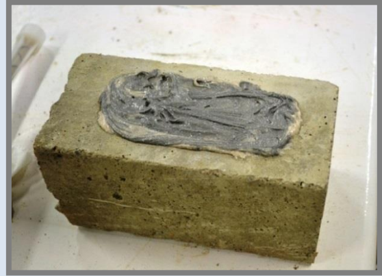
Bloc de formigó amb la resina epoxi adhesiva injectada.
