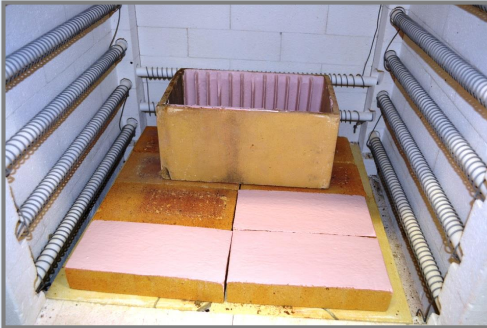
Interior del forn amb el suport i el "casset" refractari pintats amb el producte.
