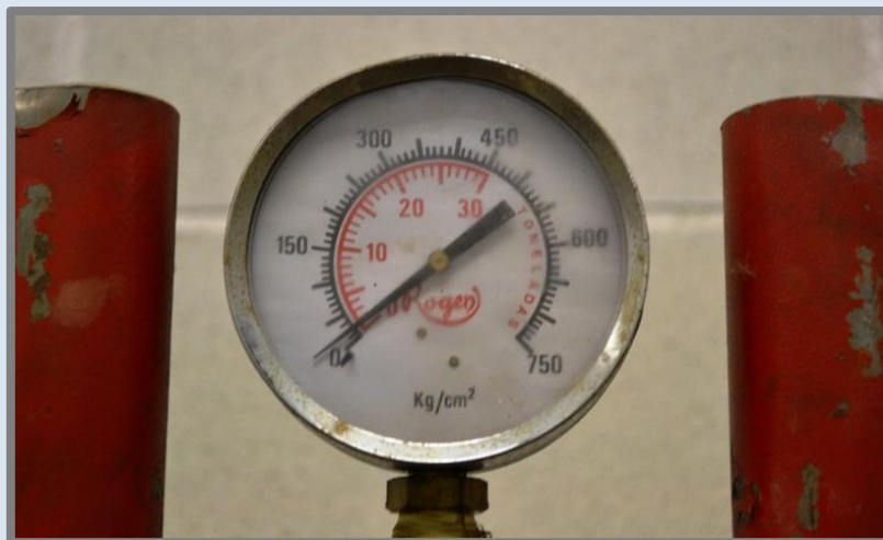
Manòmetre de la premsa hidràulica manual (premsem a 2 \text{ kg/cm}^2 ).
