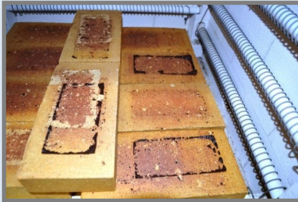
Base de les mostres F1, FA1 i FA3 enganxada al suport de rajol refractari.
