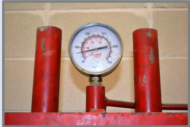
Manòmetre de la premsa hidràulica manual (premses a 10 \text{ kg/cm}^2 ).
