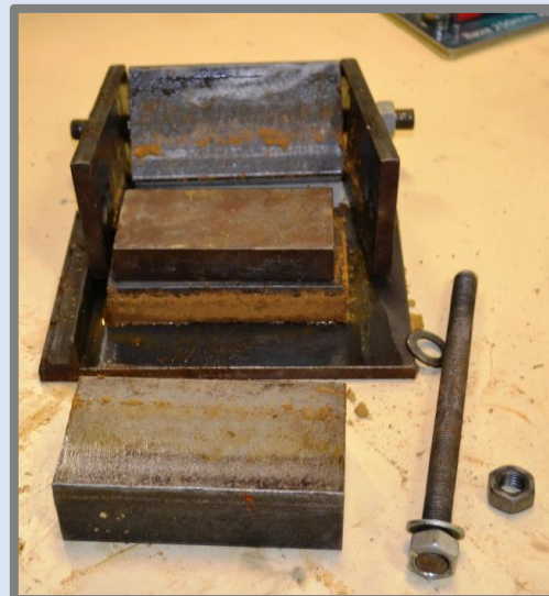
Procés d'extracció de la mostra després del premsat.
