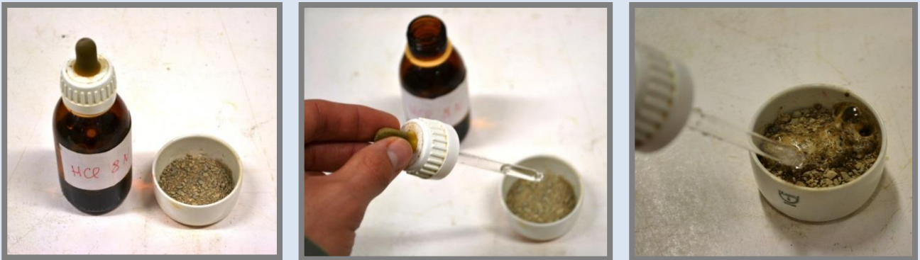
Comprovació del contingut de calç de la sorra amb àcid clorhídric.
