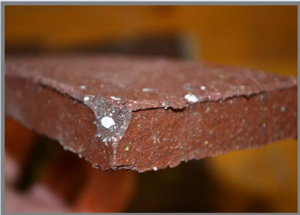
Mostres deteriorades a causa de la hidratació de la calç.
