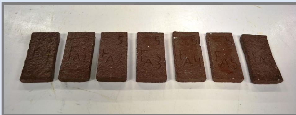
Mostres cocció 5 després d'assaig d'absorció primera tongada.
