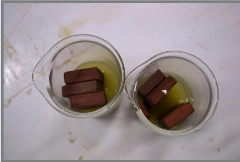
Mostres d'àcid cítric després dels 12 dies.
