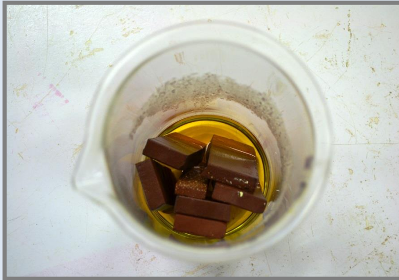
Mostres d'àcid clorhídric al 18% després dels 12 dies.
