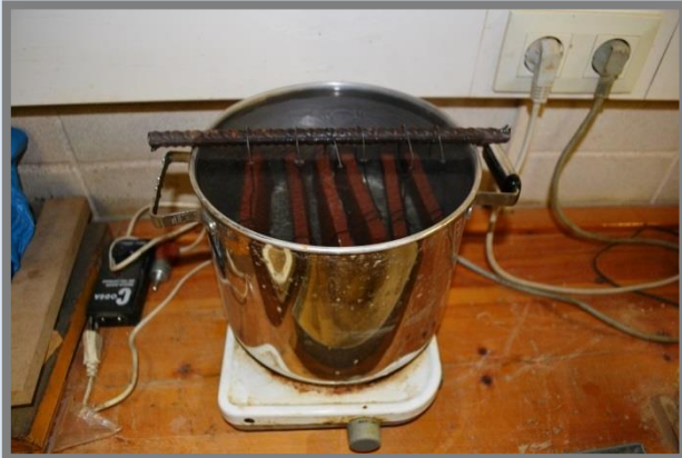
Mostres submergides a l'aigua destil·lada bullint.
