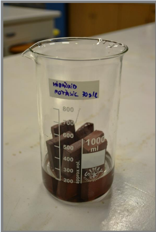
Mostres hidròxid potàssic de 30 g/l abans dels 12 dies. Fotografia: Jordi Martil i Arnau Mestre / Font: Pròpia
