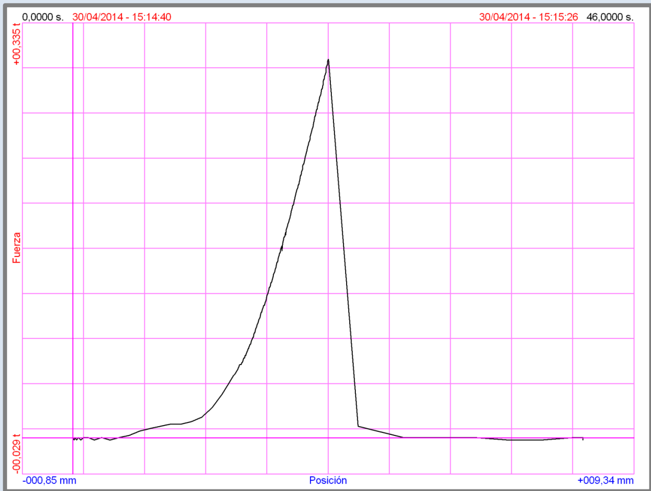
Gràfic assaig de flexió de la mostra F1G. Font: Software PCD2K
