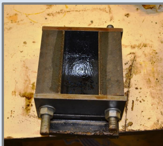
Motlle de BTC per la fabricació de les mostres.
