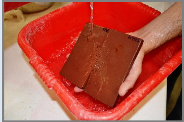
Neteja de la mostra amb aigua corrent calenta.
