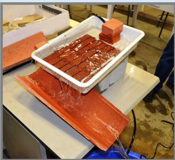
Mostres amb l'acció d'aigua corrent durant 5 dies.
