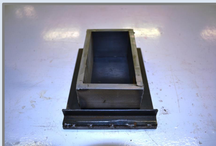
Nou motlle de 16x8 cm per la fabricació de les mostres.
