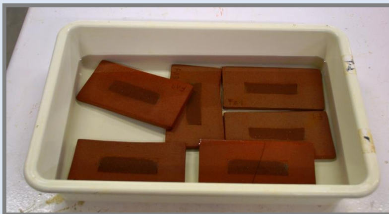
Neteja de la mostra submergint-la en un dissolvent apropiat durant 24 hores.
