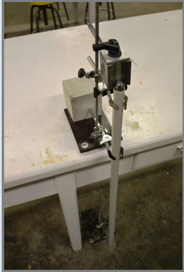
Equip llançador de la bola d'acer.
