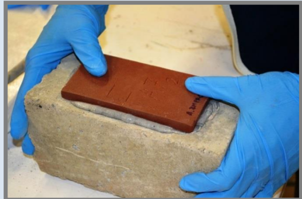
Pressionant la mostra sobre l'adhesiu.
