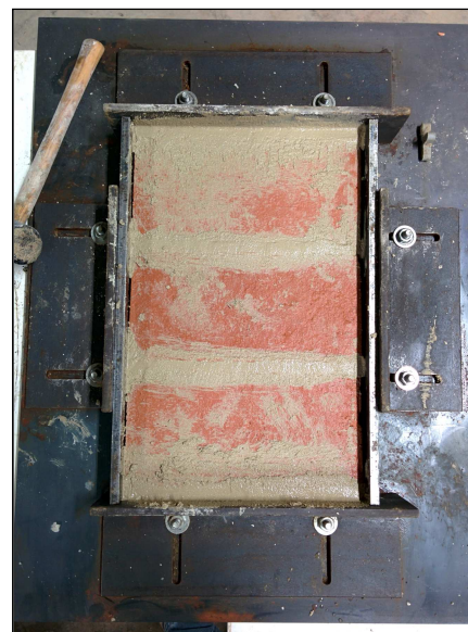
Imatge 26: Enrasar les juntes de morter.
