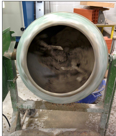
Imatge 21: El-laboració del morter de calç o de ciment gris.
