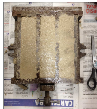
Imatge 36: Muntatge del motlle, emplenat de morter i anivellació de la superfície.
