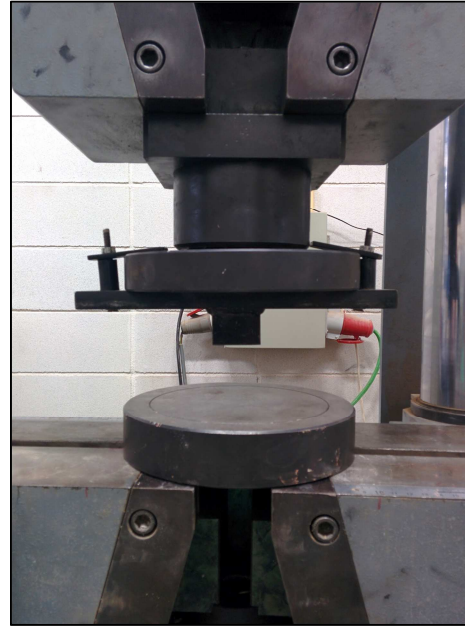
Imatge 50: Col·locació de la platina a la base de la premsa.
