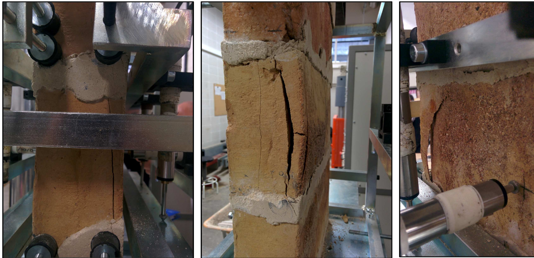
Imatge 53: Proveta amb esquerdes al lateral i dorsal de les peces.
