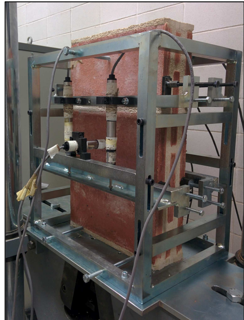
Imatge 46: Col·locació i fixació dels transductors als "gatjets".
