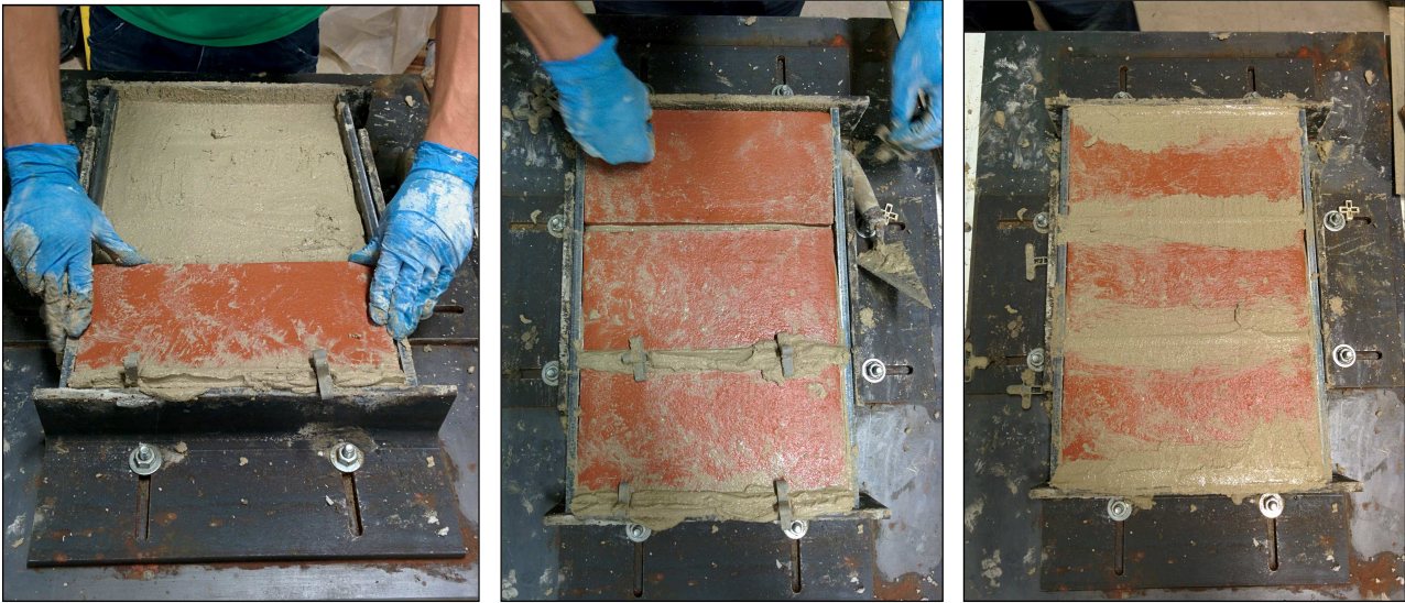
Imatge 33: Execució de la tercera capa de la proveta ceràmica.
