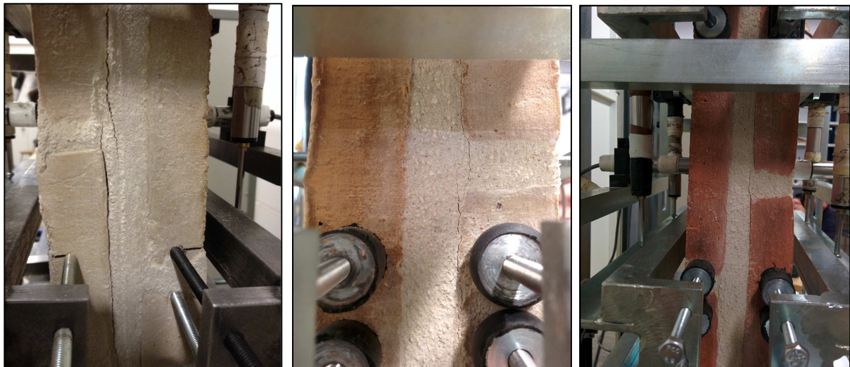
Imatge 57: Proveta amb primeres esquerdes a la interfície peça/morter del lateral.
