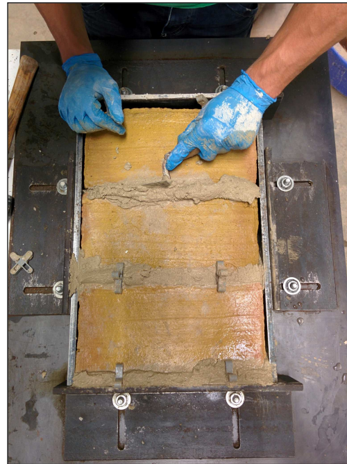
Imatge 24: Col·locació de la tercera capa peça i emplenar les dues juntes amb morter.
