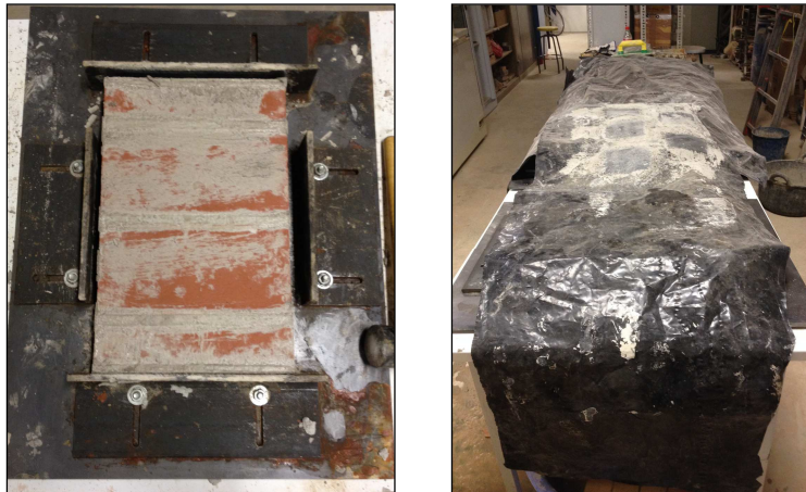
Imatge 29: Peça amb juntes enrasades i col·locació de plàstic superior
