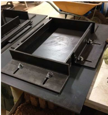
Imatge 14: Motlle metàl·lic per a fabricació de provetes.
