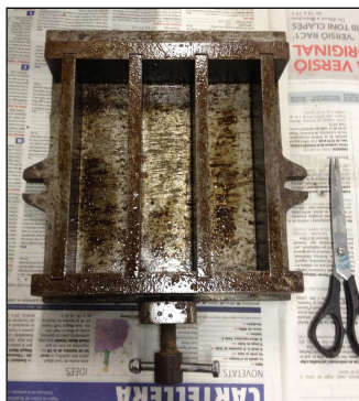
Imatge 36: Muntatge del motlle, emplenat de morter i anivellació de la superfície.
