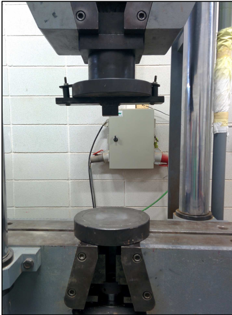
Imatge 50: Col·locació de la platina a la base de la premsa.
