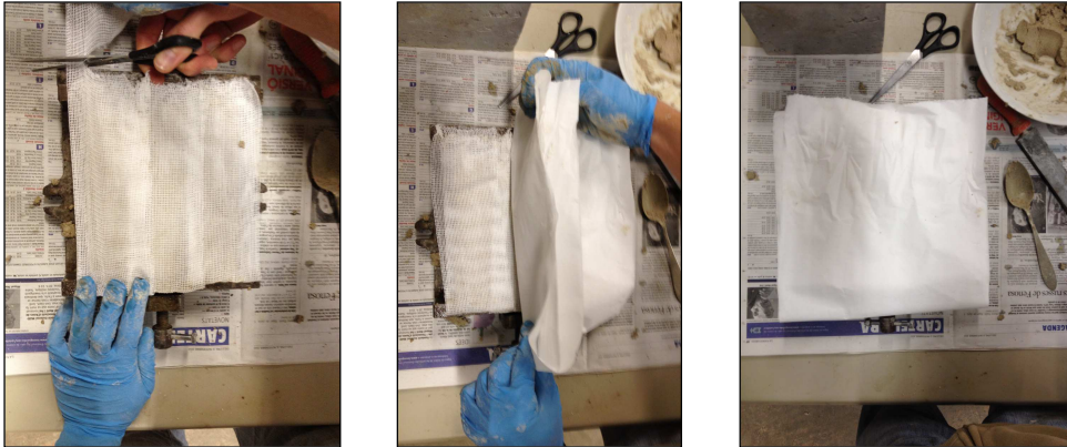
Imatge 37: Col·locació de gases sobre la proveta i sis capes de paper absorbent.
