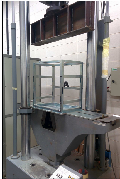
Imatge 42: Premsa amb el perfil IPE i l'utilatge metàl·lic instal·lat.
