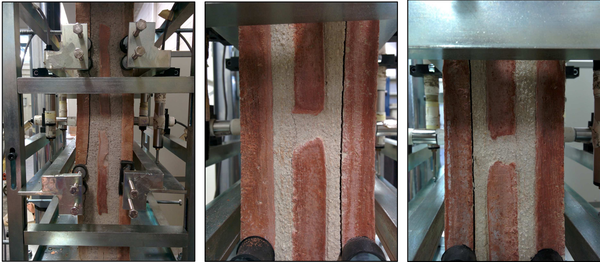
Imatge 63: Proveta amb fissures en diverses interfícies i més llargues.
