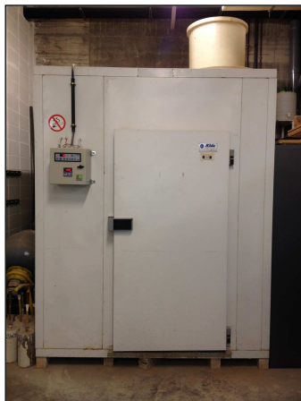
Imatge 39: Emmagatzematge de provetes en la càmera deshumidificadora.
