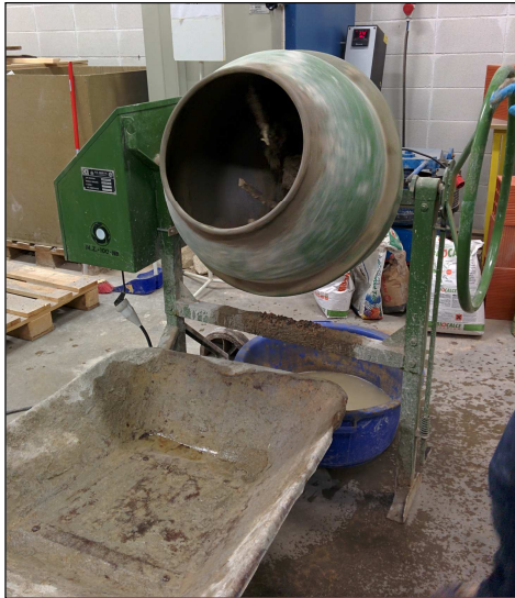
Imatge 21: El-laboració del morter de calç o de ciment gris.
