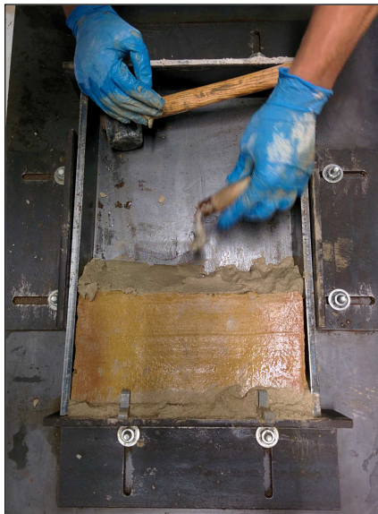
Imatge 23: Col·locació de la segona capa de morter i la segona peça ceràmica.
