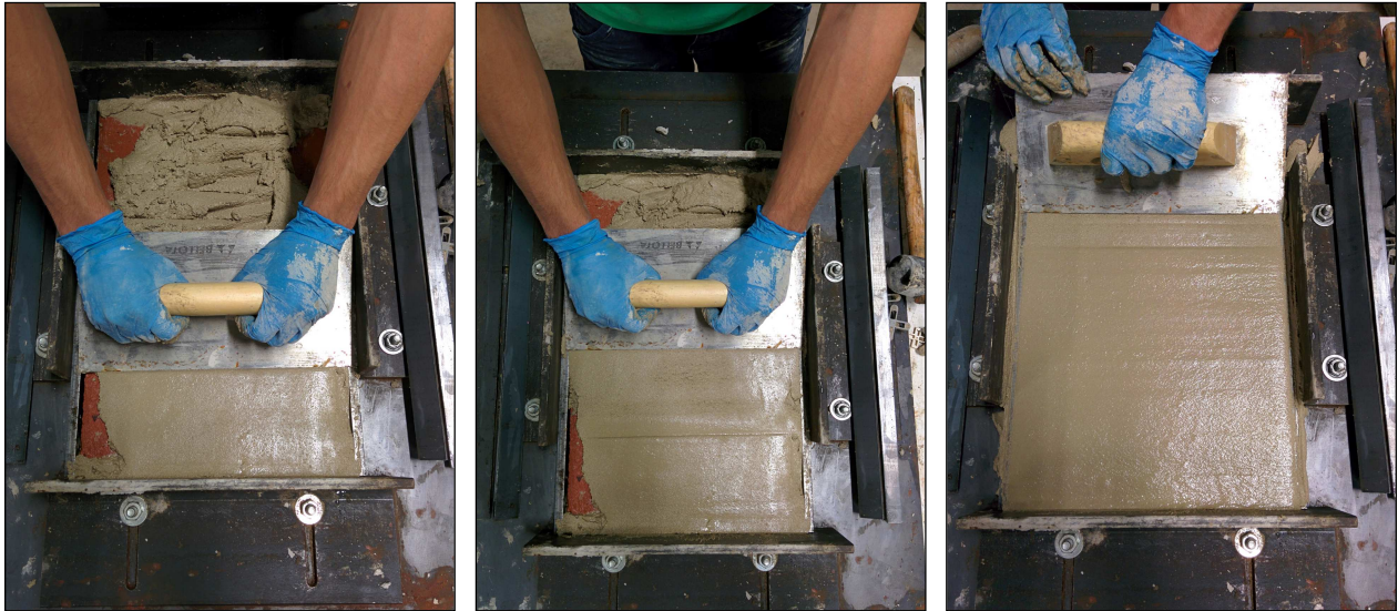
Imatge 31: Col·locació i anivellació de la junta de morter d'1cm.
