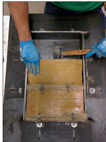
Imatge 23: Col·locació de la segona capa de morter i la segona peça ceràmica.
