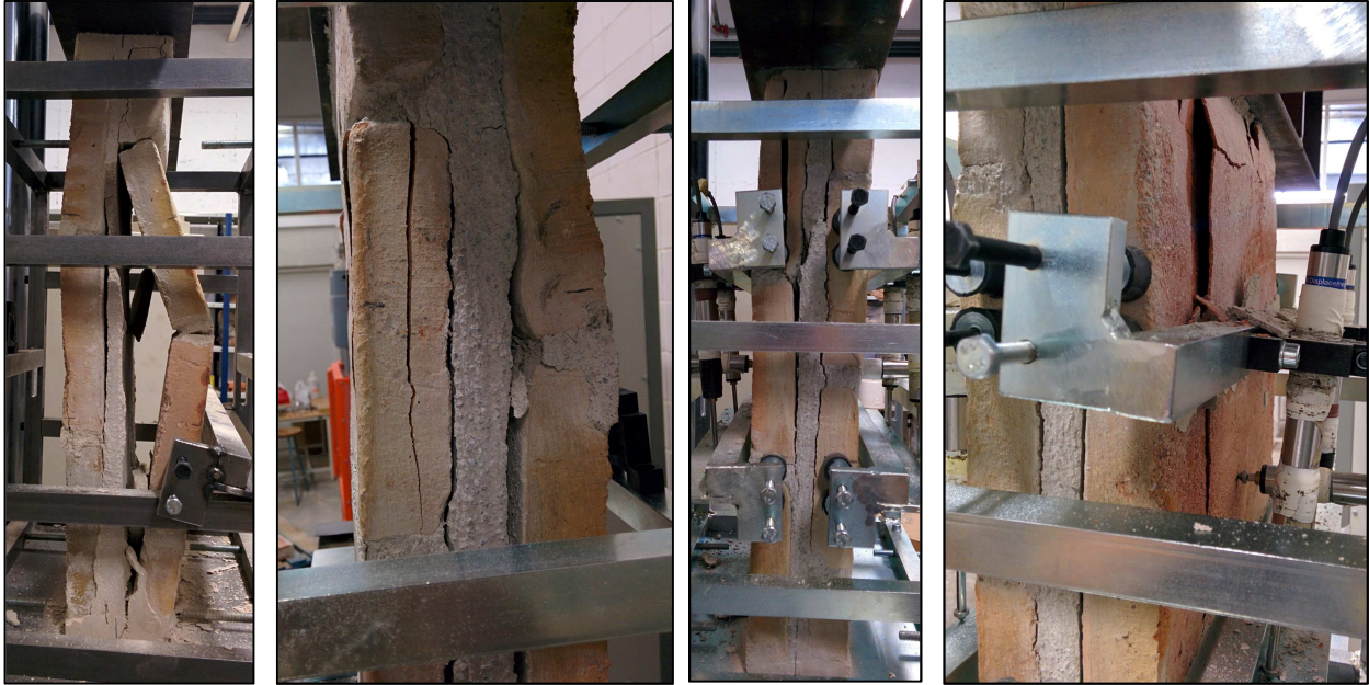
Imatge 61: Proveta col·lapsada per pandeig i/o per compressió.
