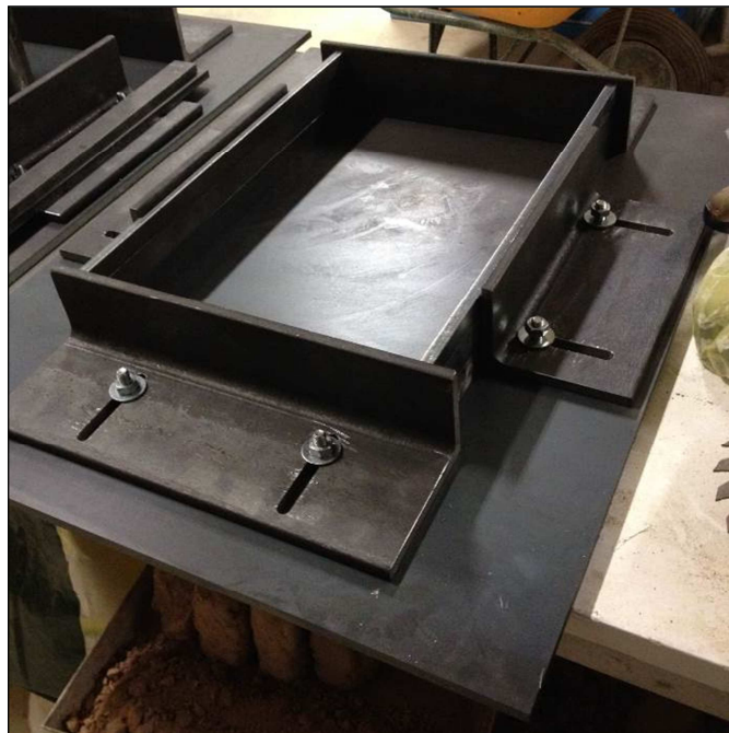
Imatge 13: Motlle metàl·lic per a fabricació de provetes.
