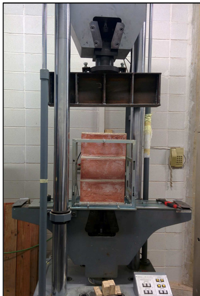
Imatge 43: Premsa amb la proveta ceràmica col·locada.
