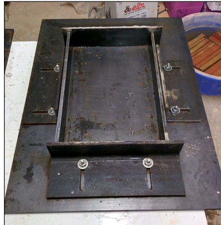
Imatge 19: Motlle ajustat i amb líquid desencofrant.
