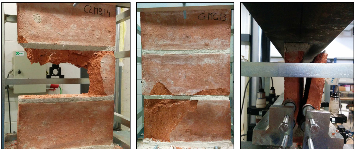
Imatge 56: Proveta amb despreniment de material causat per l'esforç de compressió.
