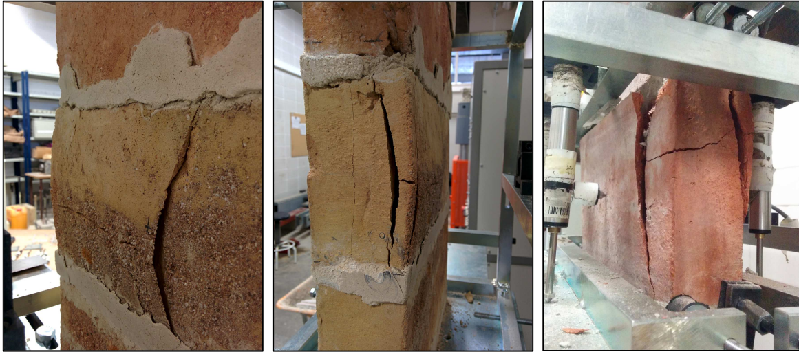
Imatge 55: Proveta amb esquerdes horitzontals al lateral, dorsal i frontal de les peces.
