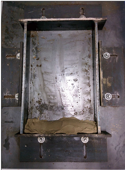
Imatge 22: Col·locació del morter al frontal i de la primera peça.
