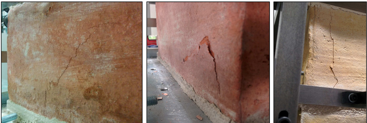
Imatge 54: Proveta amb esquerdes al lateral, dorsal i frontal de les peces superiors i inferiors.
