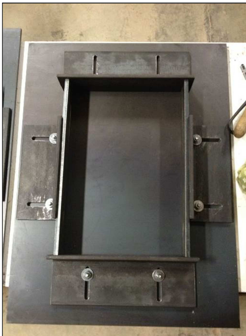
Imatge 13: Motlle metàl·lic per a fabricació de provetes.
