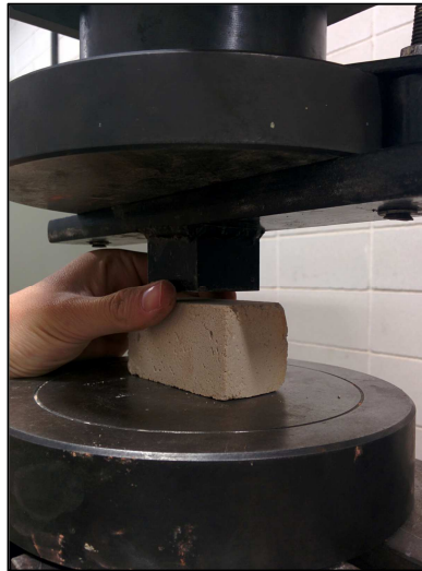
Imatge 51: Col·locació de la proveta i ajust de la premsa.
