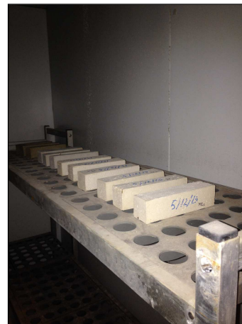
Imatge 39: Emmagatzematge de provetes en la càmera deshumidificadora.
