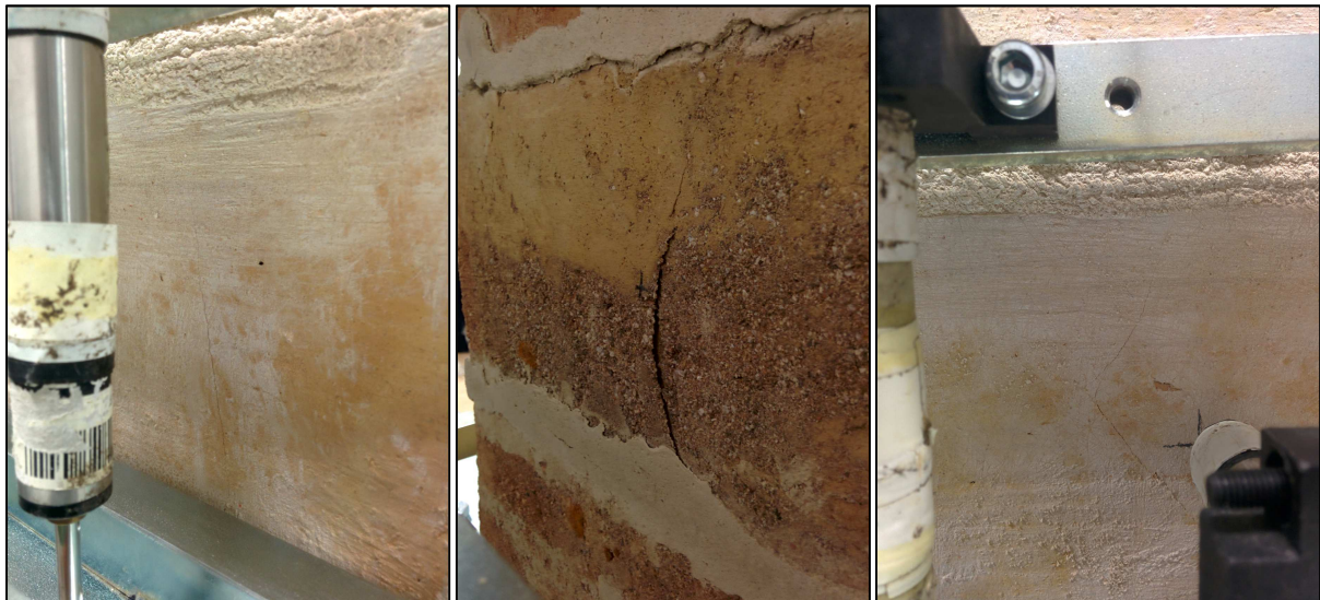
Imatge 52: Proveta amb primeres esquerdes al frontal i dorsal.
