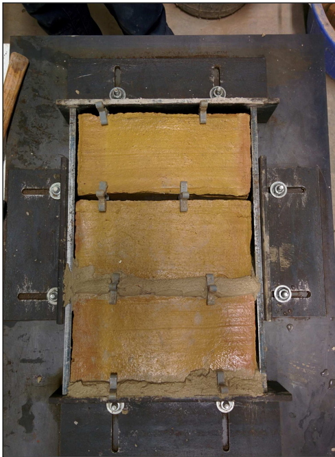
Imatge 24: Col·locació de la tercera capa peça i emplenar les dues juntes amb morter.
