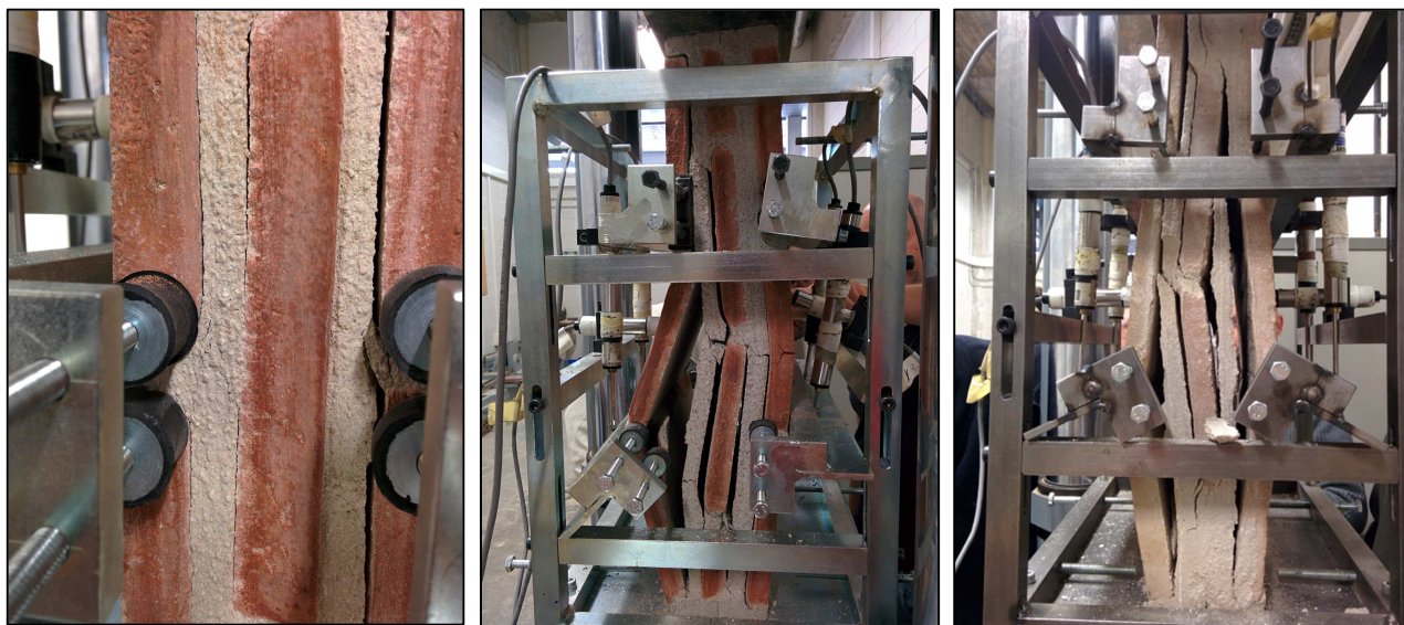
Imatge 65: Proveta amb fulla de morter tallada perpendicularment i col·lapsada per pandeig.
