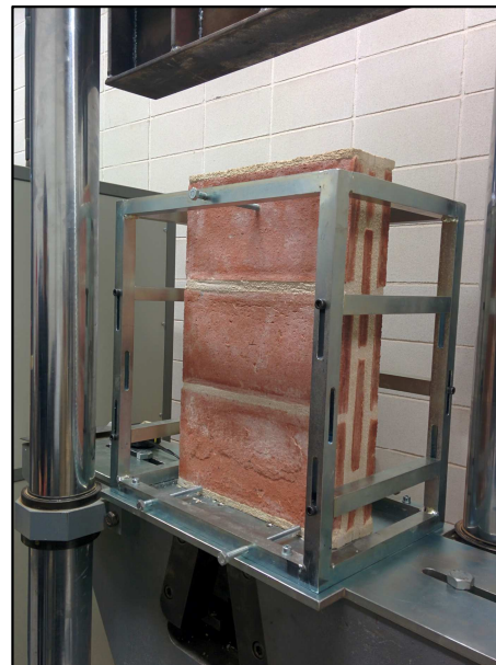
Imatge 43: Premsa amb la proveta ceràmica col·locada.
