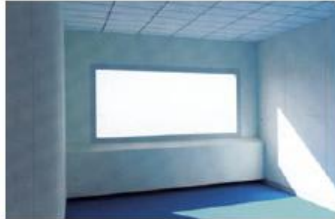
La ventana sin protección de la luz solar directa crea demasiado contraste en el interior de la sala
