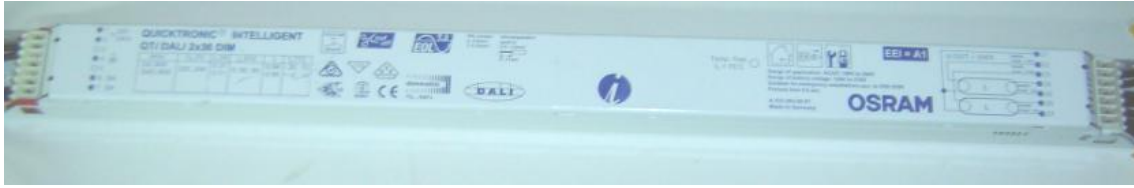
Figura 29: fotografia del balast electrònic.
