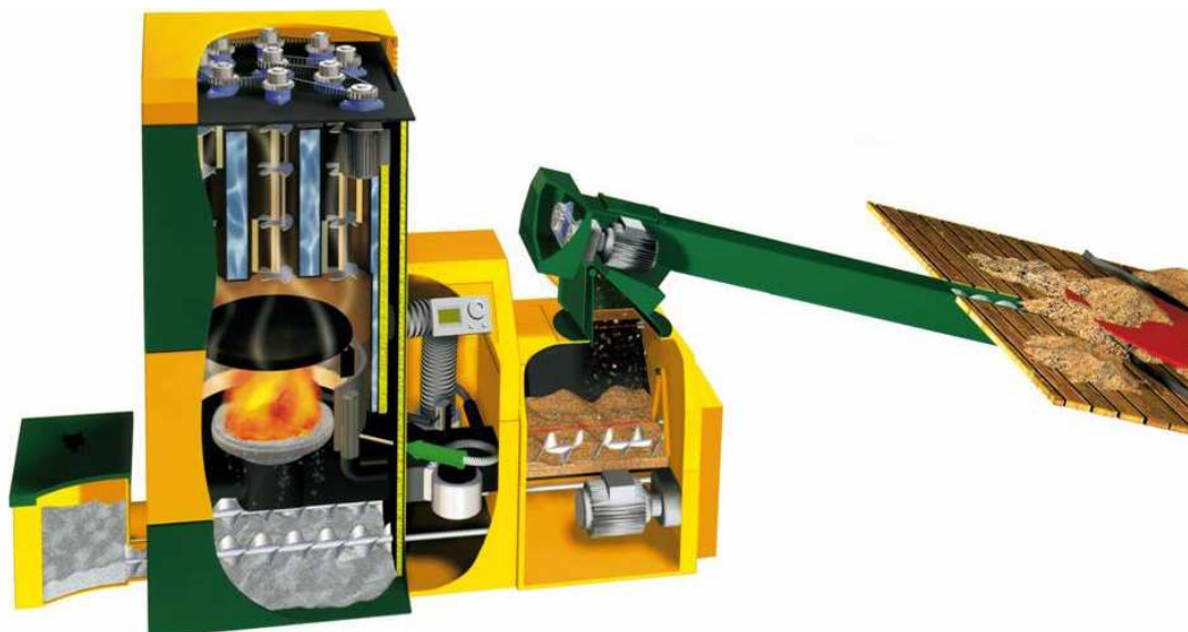
Fig. 36, funcionament de la caldera de biomassa
