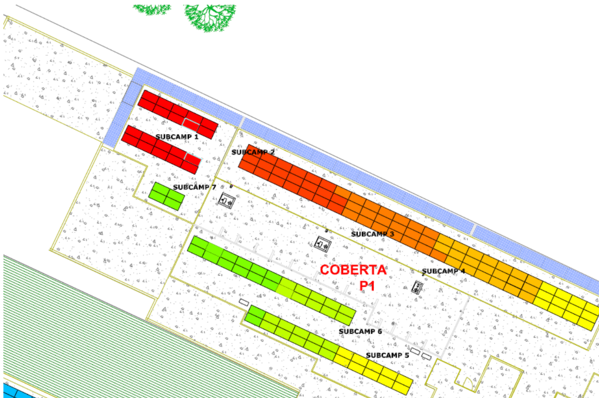
Figura 27. Col·locació dels panells sobre la coberta del P-1, conjunts de 3 i de 2 panells
