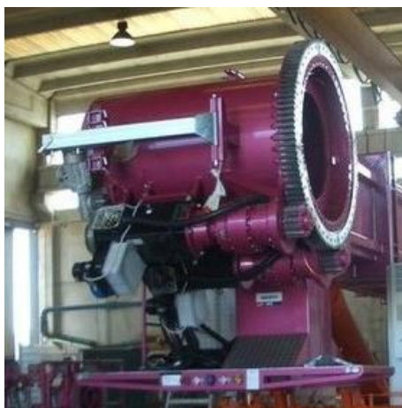
Figura 33: Imatge engranatge del sistema motriu del mecanisme de gir.
