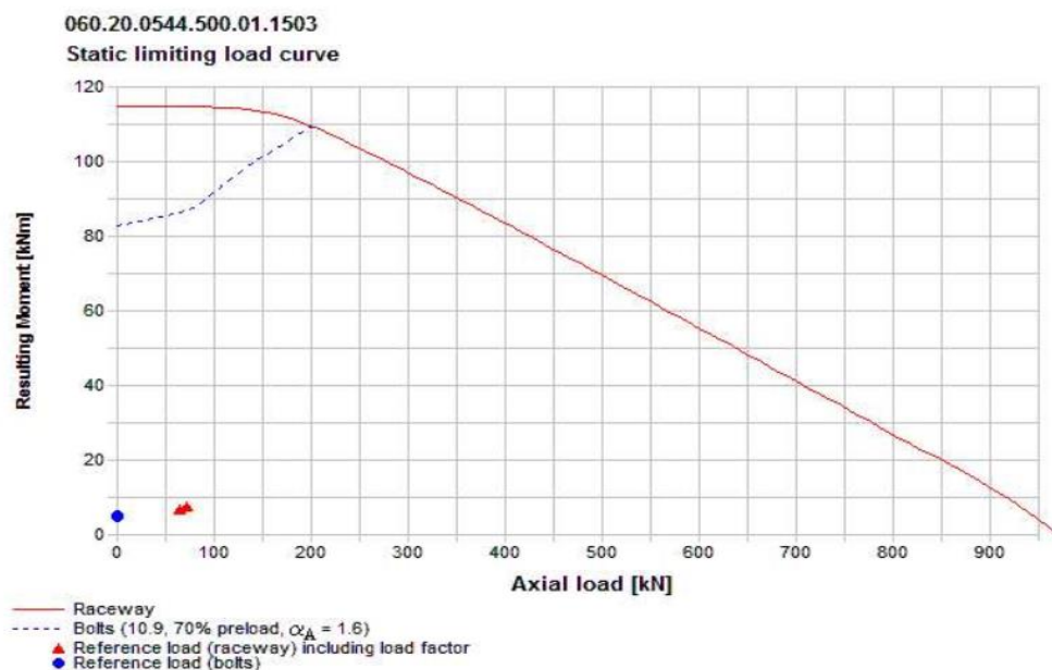
Figura 60: Corba de càrrega estàtica del rodament de les góndoles.
