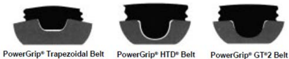
Figura 38: Esquema dels 3 perfils analitzats. Font: Gates Corporation.
