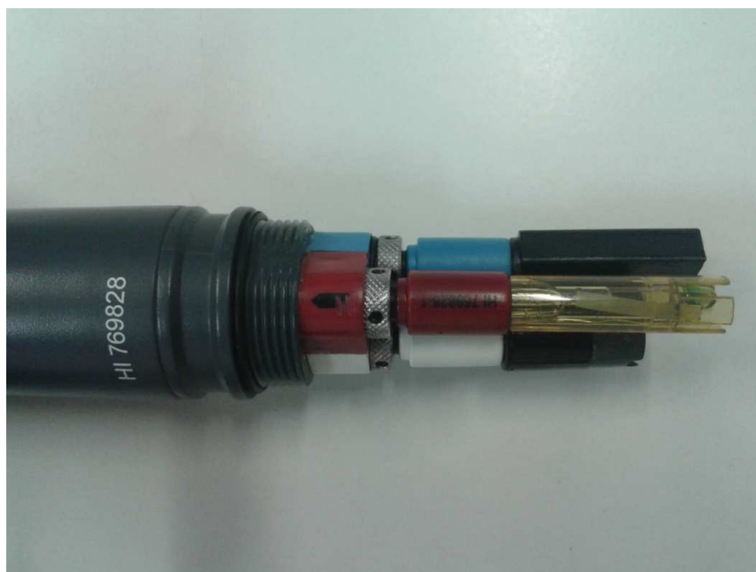
Figura D.2 – Sensors de la sonda multiparamètrica
