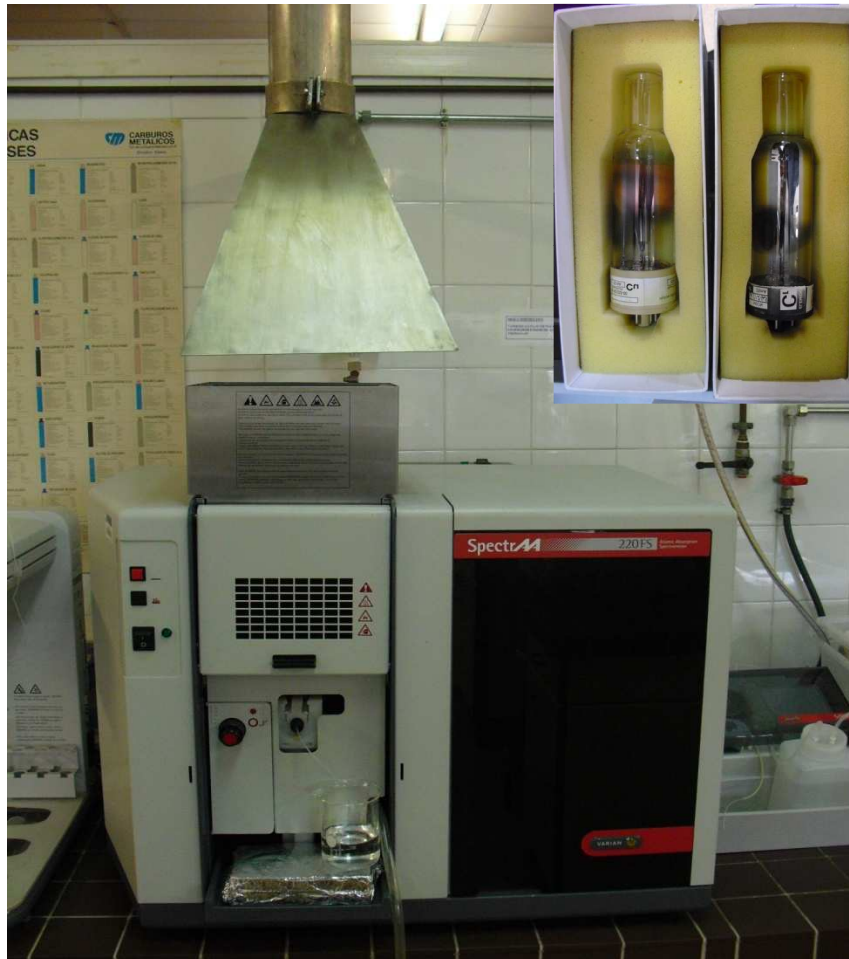
Figura D.7 – FAAS (làmpades de càtode buit per Cu i Cr)
