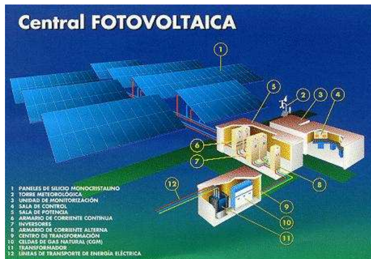
Figura 3: Central fotovoltaica Font www.xtec.es
