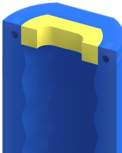
Figura 17. La zona groga no tindria suport on recolzar-se si el motllo s'imprimís verticalment
