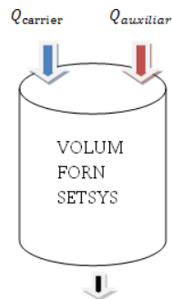
Figura 38 - Representació esquemàtica dels gasos que entren dins el forn del SETSYS
