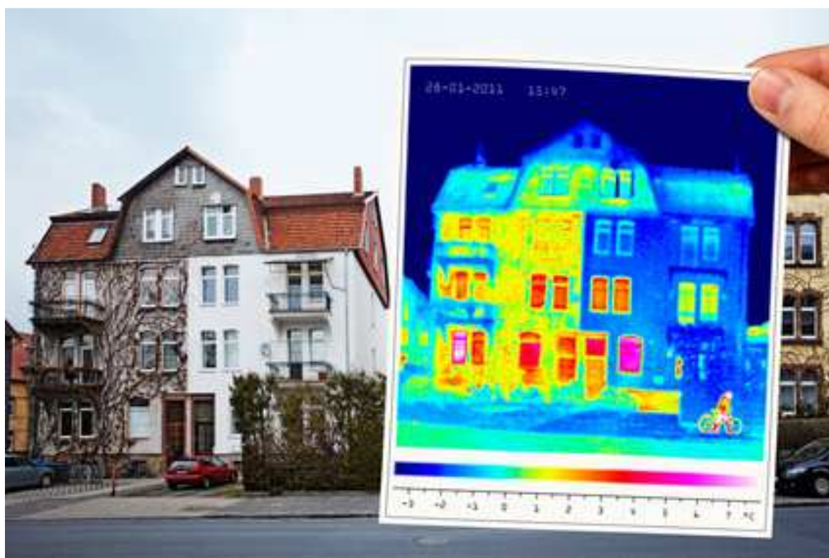
Figura 9: Importància d'una bona transmitància tèrmica (font: http://www.thermalcalconline.com ).
