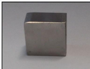
Figura 12: Proveta d'acer inoxidable 316 L.
