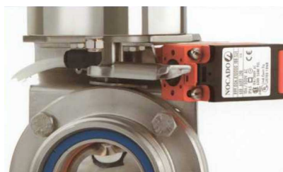
Figura 24. Detall del microrruptor en una electrovàlvula nocado
