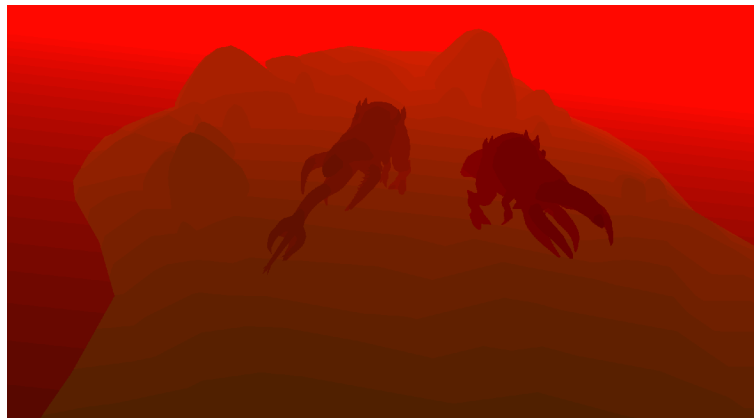
Figura 9.6: Buffer DSF que conté la profunditat discreta i un identificador d'objecte
