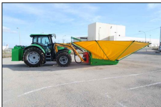
Figura 5.4. Paraigües vibrador amb peladora incorporada en posició de vibració i recollida de l'ametlla caiguda de l'arbre (Font: Estupiña, 2013).
