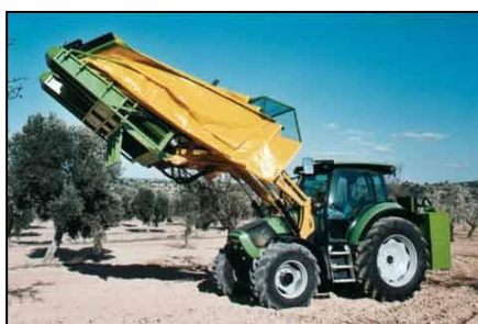
Figura 5.5. Paraigües vibrador amb peladora incorporada en posició de descàrrega del dipòsit acumulador d'ametlla pelada. S'obre la trapa inferior i descarrega a un carro remolc (Font: Estupiña, 2013).
