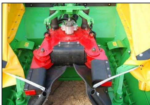
Figura 5.8. Foto detall del vibrador del sistema paraigües vibrador amb peladora (Font: Estupiña, 2013).
