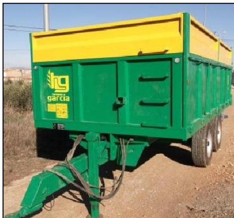
Figura 5.9. Carro remolc amb elevador hidràulic, propietat de l'empresa (Font pròpia).
