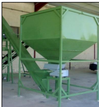
Figura 5.12. Tolva de preneteja amb reixa, alimentador vibrant i cargol sense fi (Font: Indústries Garriga SL, La Selva del Camp, Catalunya, 2013).
