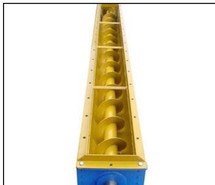
Figura 5.13. Foto detall de l'interior d'un transportador de cargol sense fi (Font: Hemac, 2013).
